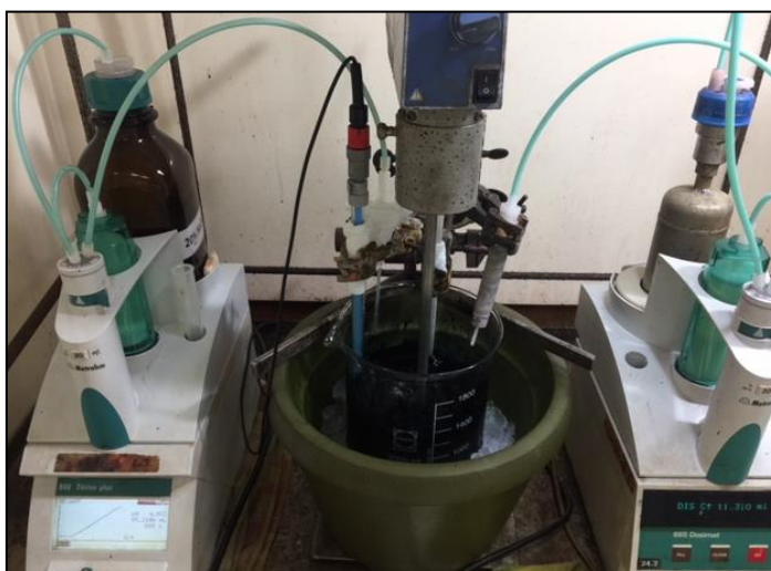
รูปที่ 5. 1 การจำลองกระบวนการสังเคราะห์สี้อม REACTIVE-A Blue Base ในระดับปฏิบัติการ
