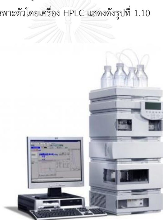
รูปที่ 1. 10 เครื่อง HPLC ที่ใช้วิเคราะห์คุณภาพในกระบวนการสังเคราะห์สีย้อม
