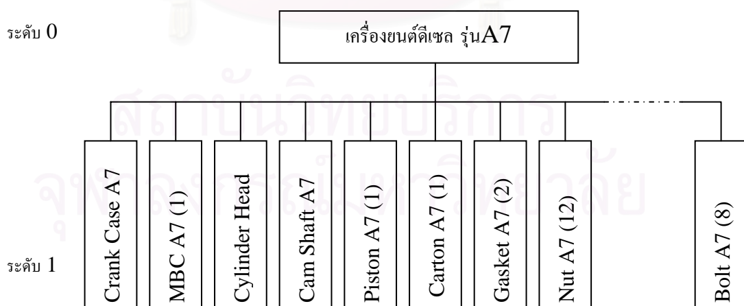
รูปที่ 4.9 ตัวอย่างโครงสร้างผลิตภัณฑ์สำเร็จรูปประเภทเครื่องยนต์ดีเซลของโรงงานตัวอย่าง
