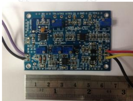
รูปที่ 3.6 แผ่นพิมพ์วงจรขยายสัญญาณ
