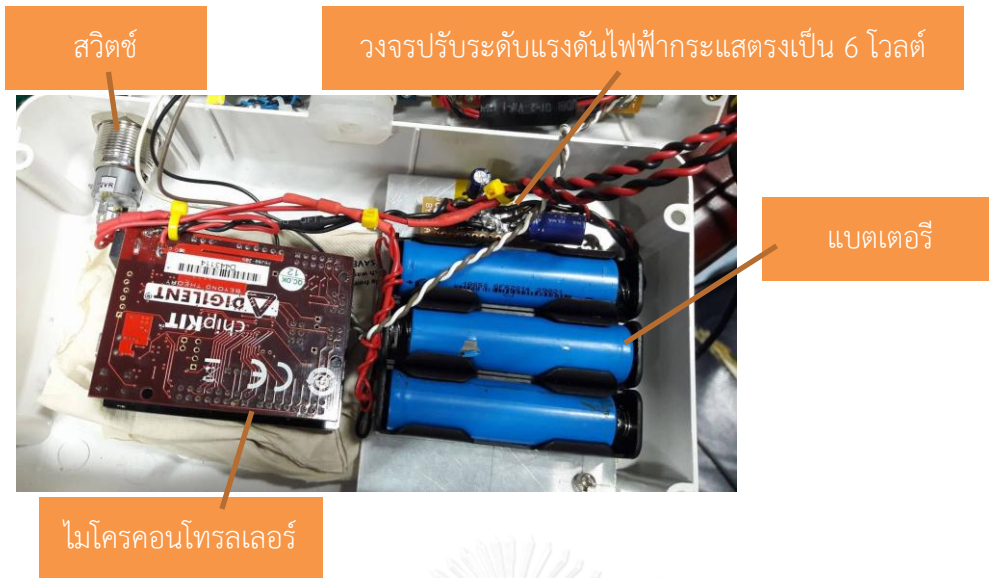
รูปที่ 3.18 ภายในอุปกรณ์ระบุชนิดไอโซโทปรังสีที่พัฒนาขึ้นฝั่งจอแสดงผล
