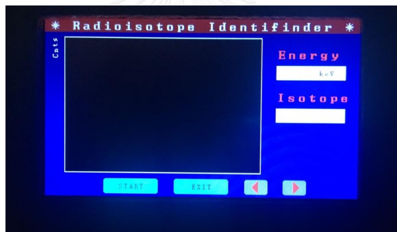
รูปที่ 4.29 หน้าเมนูหลักของอุปกรณ์ระบุชนิดไอโซโทปรังสีที่พัฒนาขึ้น
