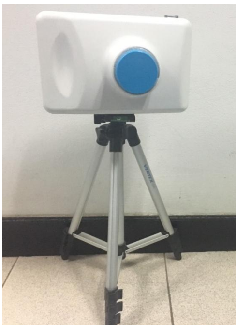
รูปที่ 3.16 อุปกรณ์ระบุชนิดไอโซโทปที่พัฒนาขึ้น
