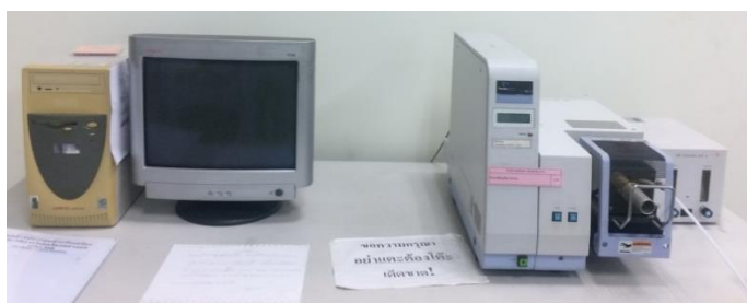
รูปที่ 3.7 เครื่องวิเคราะห์สมบัติเชิงความร้อน TG/DTA analyzer
