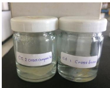
รูปที่ 3.6 การแช่เมมเบรนตัวอย่างทั้ง 2 ชนิด ในน้ำบริสุทธิ์ที่เป็นภาวะปิด
