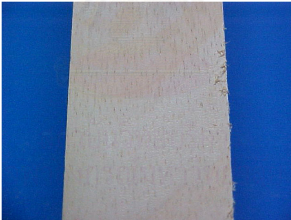
รูปที่ 4.55 ผิวนิรของชิ้นงานที่ผ่านการขัดชั้นที่ 400 ของการควบคุมอัตราการป้อนชิ้นงานด้วยเครื่องควบคุม
