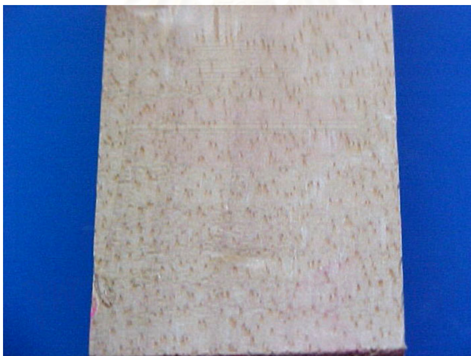
รูปที่ 4.39 ผิวชิ้นงานที่ได้จากการตัดชิ้นที่ 1 ด้วยเครื่องควบคุมอัตราการป้อน
