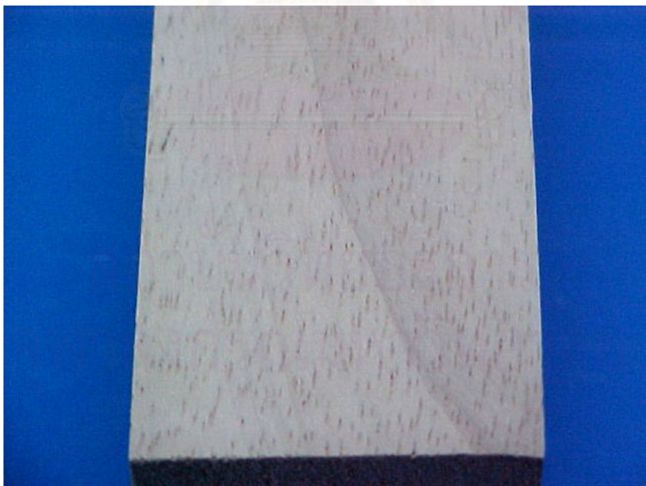
รูปที่ 4.52 ผิวนิรนาที่ผ่านการขัดขึ้นที่ 1 ของการควบคุมอัตราการป้อนงานโดยพนักงานในสายการผลิต
