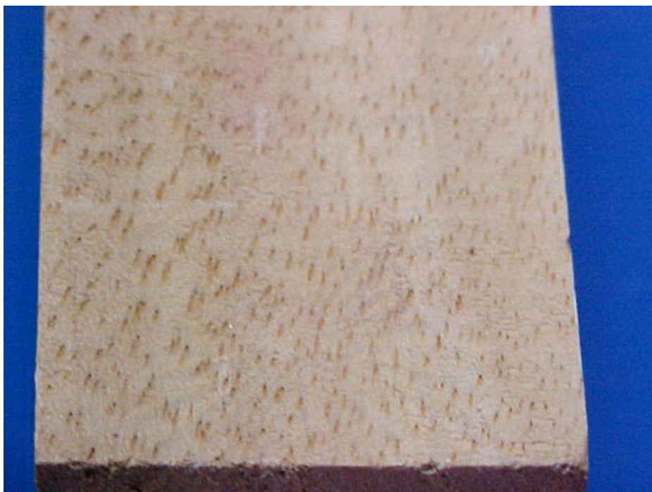
รูปที่ 4.39 ผิวชิ้นงานที่ได้จากการตัดชิ้นที่ 1 ด้วยเครื่องควบคุมอัตราการป้อน
