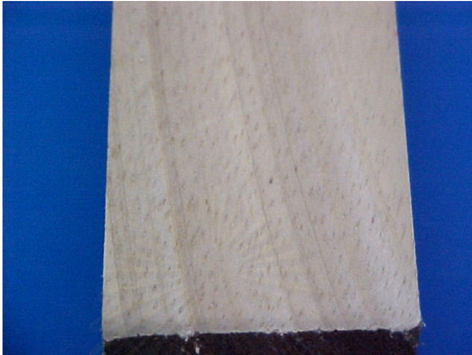
รูปที่ 4.55 ผิวนิรของชิ้นงานที่ผ่านการขัดชั้นที่ 400 ของการควบคุมอัตราการป้อนชิ้นงานด้วยเครื่องควบคุม
