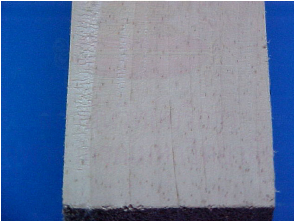
รูปที่ 4.54 ผิวนิรขณงานที่ผ่านการขัตขัันที่ 250 ของการควบคุมอัตราการป้อนโดยพนักงานในสายการผลิต
