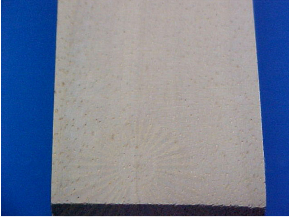
รูปที่ 4.53 ผิวนิรขณงานที่ผ่านการขัตขัันที่ 250 ของการควบคุมอัตราการป้อนขัันงานด้วยเครื่งควบคุม
