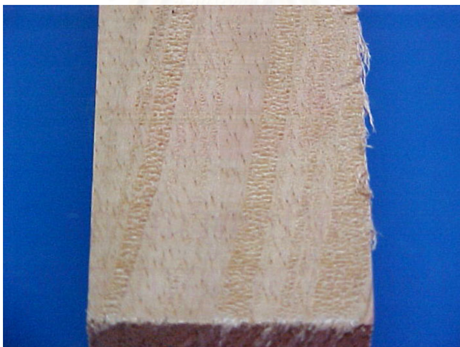
รูปที่ 4.46 ผิวงานที่ผ่านการตัดชิ้นที่ 400 ของการป้อนชิ้นงานโดยพนักงานในสายการผลิต
