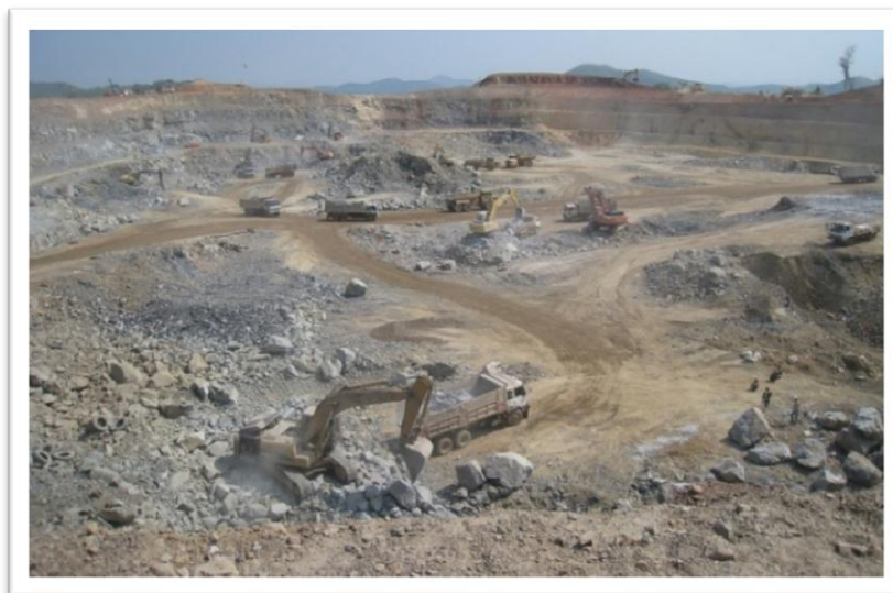
รูปที่ 2.1 ลักษณะของหน้าเหมือง ซึ่งใช้วิธีเหมืองทาบ ที่มา : สถาบันวิจัยสภาวะแวดล้อม (2555)
