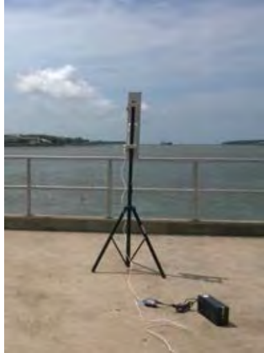
รูปที่ 3.16: สายอากาศขนาด 19 dBi บนเขื่อนบริเวณวัดช่องลม
