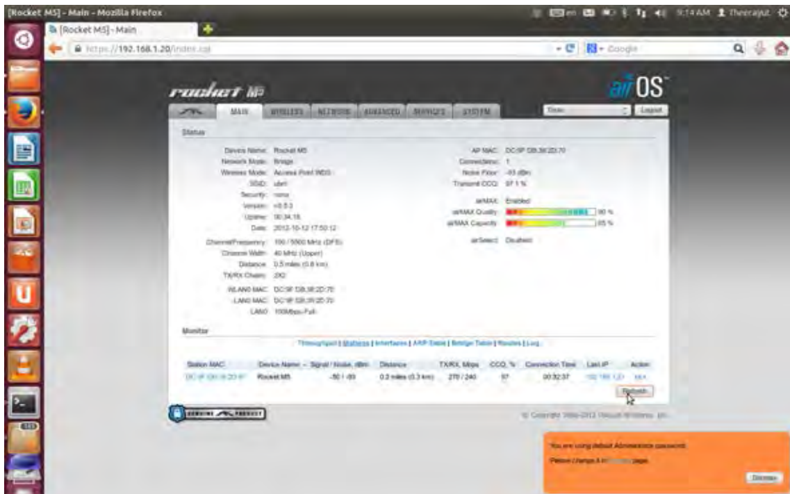
รูปที่ 3.4: การวัดความเข้มของสัญญาณที่ผู้รับโดยใช้อุปกรณ์ร็อกเก็ต เอ็ม 5
