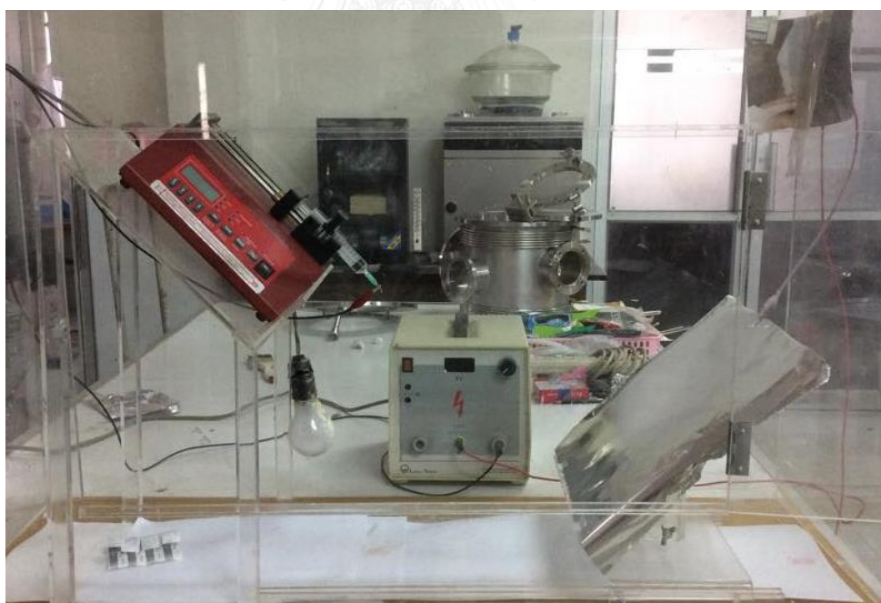
ภาพที่ 3.2 ส่วนประกอบต่างๆของเครื่องปั่นเส้นใยด้วยไฟฟ้าสถิต
