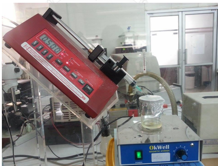
ภาพที่ 3.1 การตั้งเครื่องมือในระหว่างการเตรียมสารละลายอิมัลชัน
