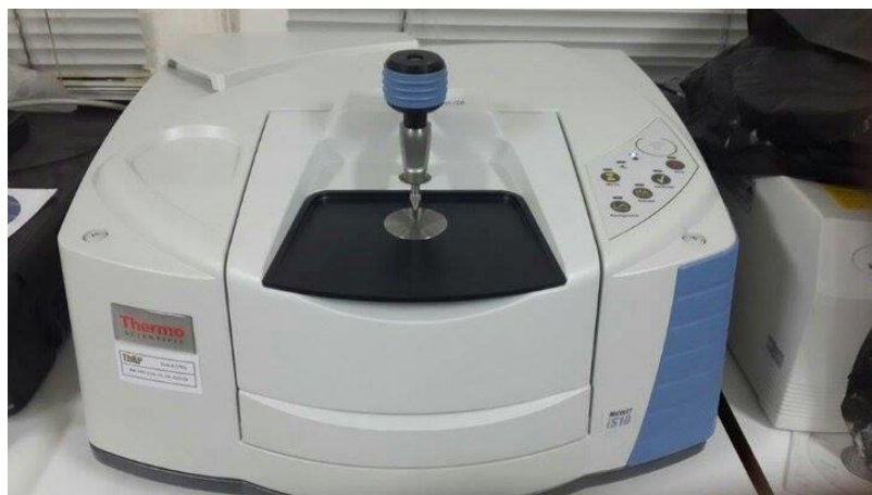
ภาพที่ 3.3 เครื่องแอสเพนนูเอตโททรีฟลักซ์ฟลูออริสฟอรัมอินฟราเรดสเปกโตรมิเตอร์ รุ่น Nicolet iS10 ATR-FTIR
