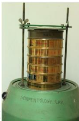
รูปที่ 3- 4 เครื่อง sieve analysis
