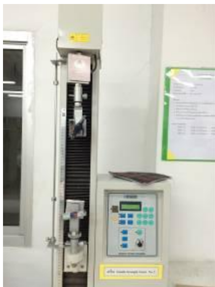
รูปที่ 3.13 เครื่องทดสอบแรงดึง รุ่น GT-7010-D2E บริษัท GOTECH
