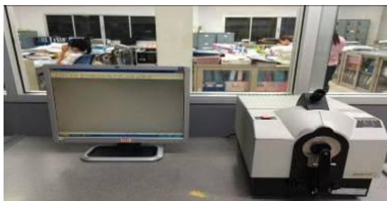
รูปที่ 3.8 เครื่องวัดสี (CCM) รุ่น 1200-1079 บริษัท Datacolor International
