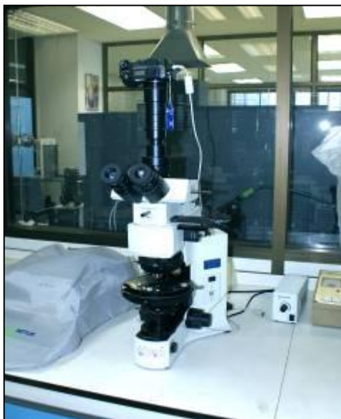
รูปที่ 3.16 กล้องจุลทรรศน์ไมโครสโคป (Microscope) รุ่น BX41 บริษัท OLYMPUS
