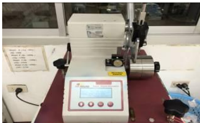
รูปที่ 3.14 เครื่องทดสอบแรงฉีกแบบดิจิทัล รุ่น M008E บริษัท SDL Atlas Inc
