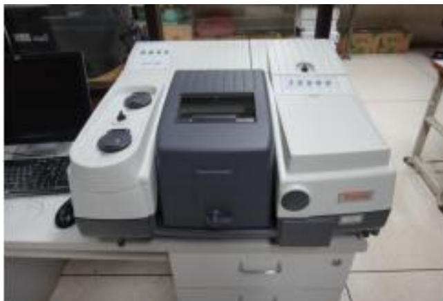
รูปที่ 3.6 เครื่อง FT-IR รุ่น Nicolet 6700 บริษัท Thermo Fisher
