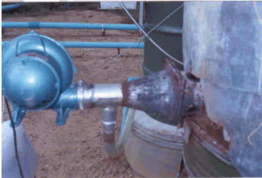
รูปที่ 4.35 แสดงชุดหัวเผาของชุดเตาเผาระเหยแบบ Fire Tube ที่มีการเจาะรูเพื่อเพิ่มปริมาณอากาศส่วนเกินหลังจุดติดไฟ
