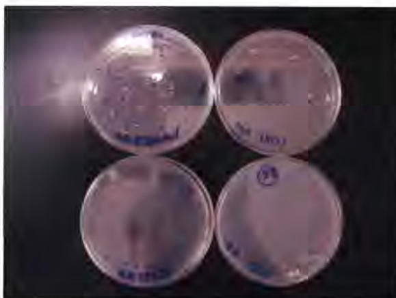
รูปที่26 การทดสอบประสิทธิภาพเครื่องกรองอากาศ
