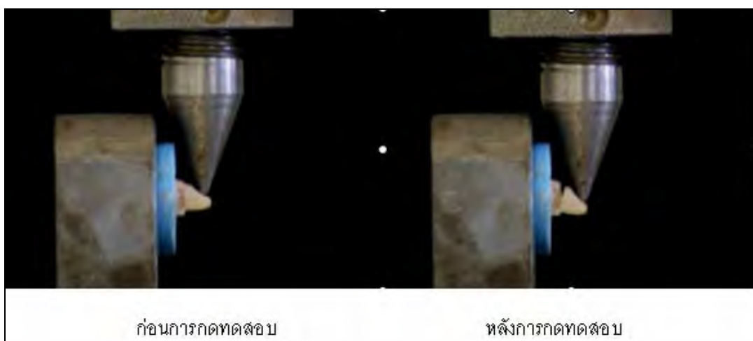
ภาพที่ 16 แสดงลักษณะของซี่นตัวอย่างก่อนและหลังการกดทดสอบ
