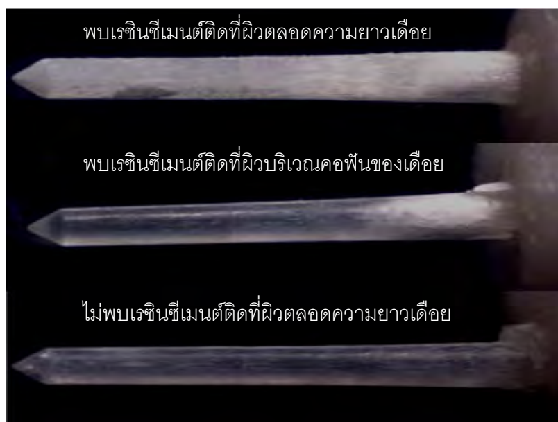
รูปที่ 19 ลักษณะผิวของเดือยพื้นที่หลุดของชิ้นตัวอย่างภายหลังทดสอบ
