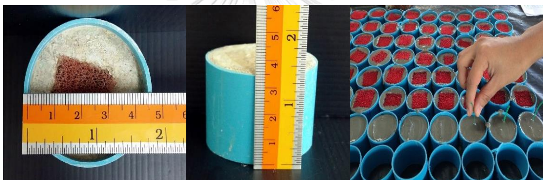
รูปที่ 3.5 ขนาดของท่อพีวีซีรูปทรงกระบอกที่ใช้เป็นแบบในการผลิตวัสดุเทียม
