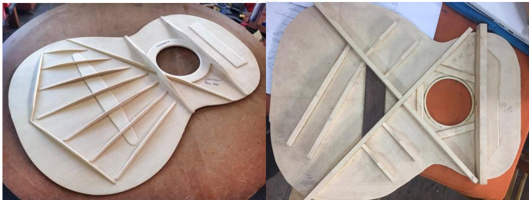
ภาพที่ 11 ภาพโครงสร้างแฟนเบรสซิ่งและเอ็กซ์เบรสซิ่ง
