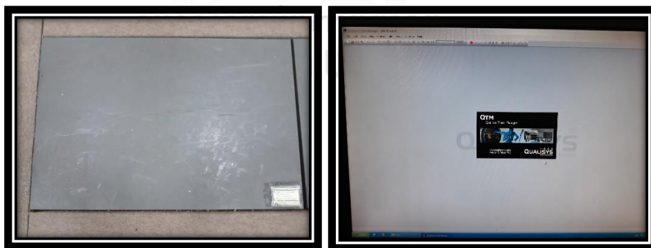
ภาพที่ 10 (ซ้าย) แสดงแผ่นรับแรงกดฝ่าเท้า (Bertec Force plate FP4060-08) ภาพที่ 3.5 (ขวา) แสดงโปรแกรมประมวลผล Qualisys Track Manager
