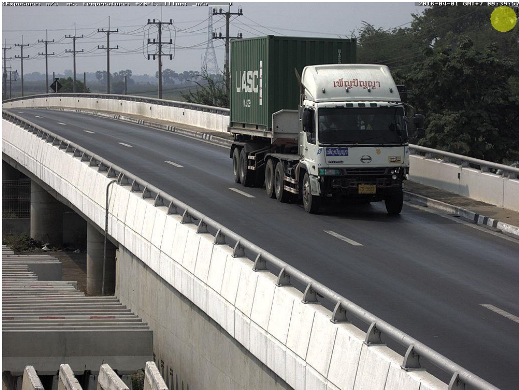
รูปที่ 5.13 รถบรรทุกกึ่งพ่วง 18 ล้อหนัก 17.6 ตัน วิ่งด้วยความเร็ว 67 กิโลเมตรต่อชั่วโมง
