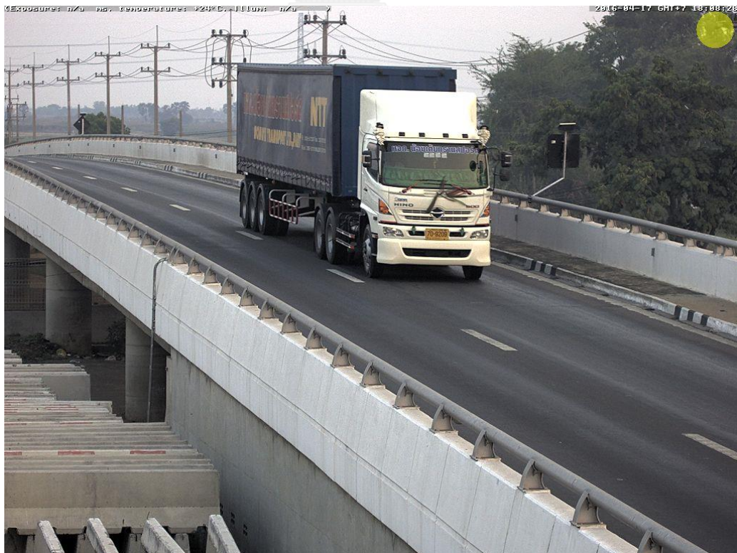
รูปที่ 5.14 รถบรรทุกกึ่งพ่วง 22 ล้อหนัก 40.7 ตัน วิ่งด้วยความเร็ว 76 กิโลเมตรต่อชั่วโมง
