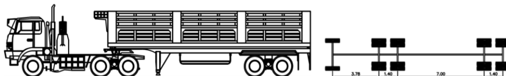
รูปที่ 4.51 รายละเอียดรถบรรทุกกึ่งพ่วง 18 ล้อ
