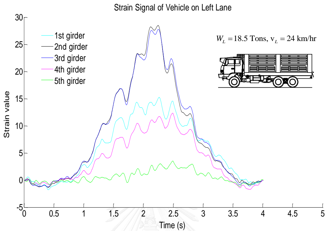
รูปที่ 5.8 สัญญาณความเค้นขึงรถบรรทุกทุกบนช่องจราจรซ้าย
