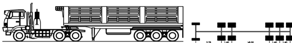
รูปที่ 4.53 รายละเอียดรถบรรทุกกึ่งพ่วง 22 ล้อ
