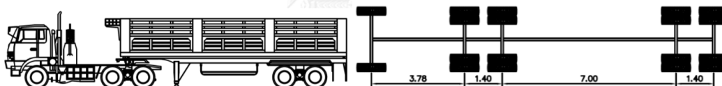
รูปที่ 4.61 รายละเอียดรถบรรทุกกึ่งพ่วง 18 ล้อ
