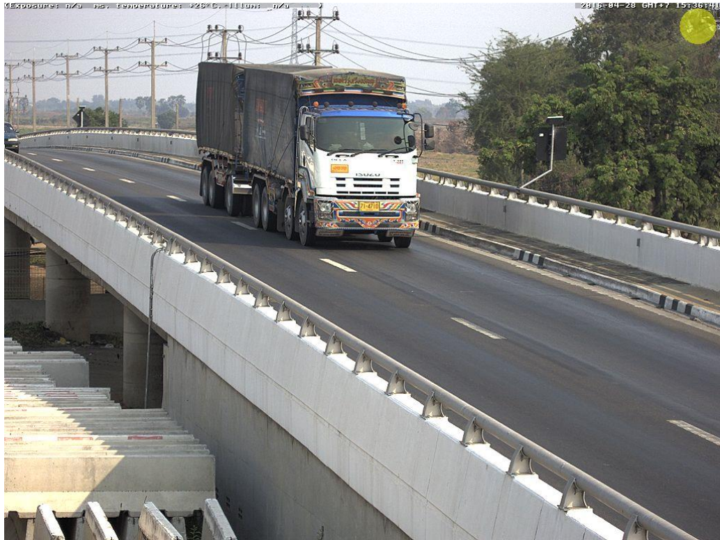
รูปที่ 5.15 รถบรรทุกพ่วง 24 ล้อหนัก 44.4 ตัน วิ่งด้วยความเร็ว 28 กิโลเมตรต่อชั่วโมง
