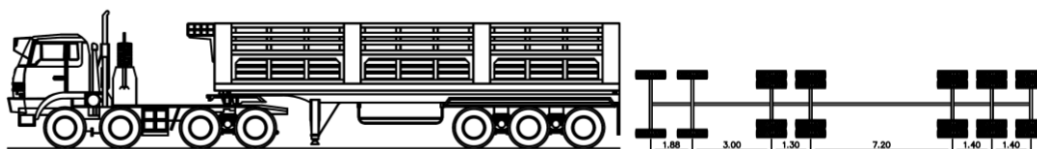
รูปที่ 4.54 รายละเอียดรถบรรทุกกึ่งพ่วง 24 ล้อ
