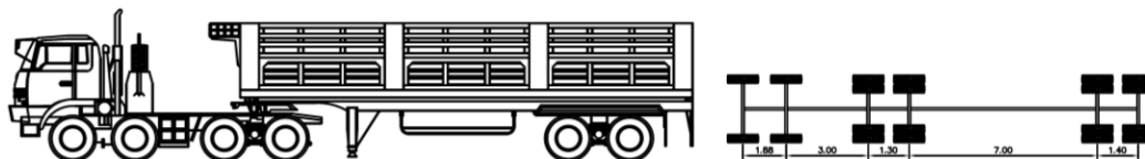
รูปที่ 4.52 รายละเอียดรถบรรทุกกึ่งพ่วง 20 ล้อ
