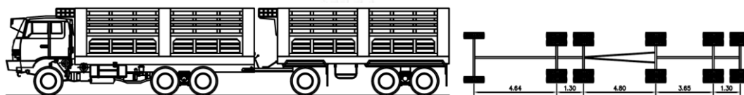
รูปที่ 4.57 รายละเอียดรถบรรทุกพ่วง 22 ล้อ
