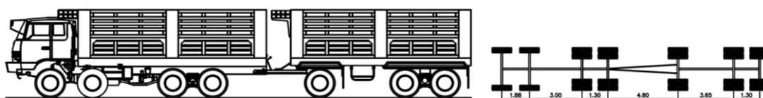
รูปที่ 4.58 รายละเอียดรถบรรทุกพ่วง 24 ล้อ
