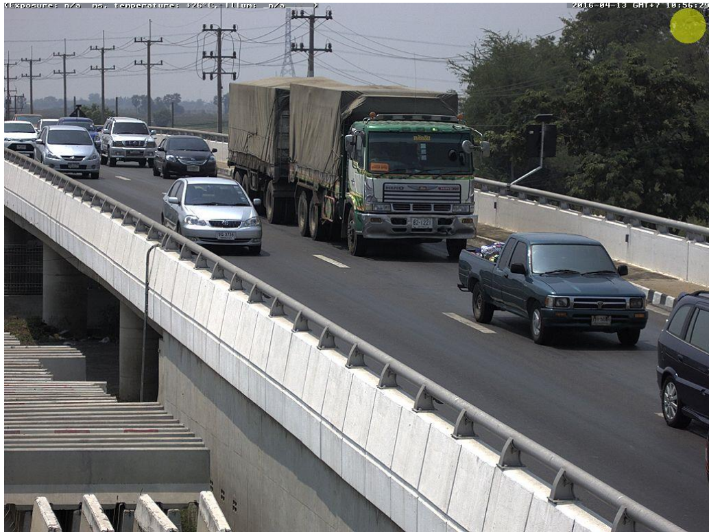
รูปที่ 5.49 รถบรรทุกพ่วง 22 ล้อหนัก 43 ตัน วิ่งด้วยความเร็ว 31 กิโลเมตรต่อชั่วโมง
