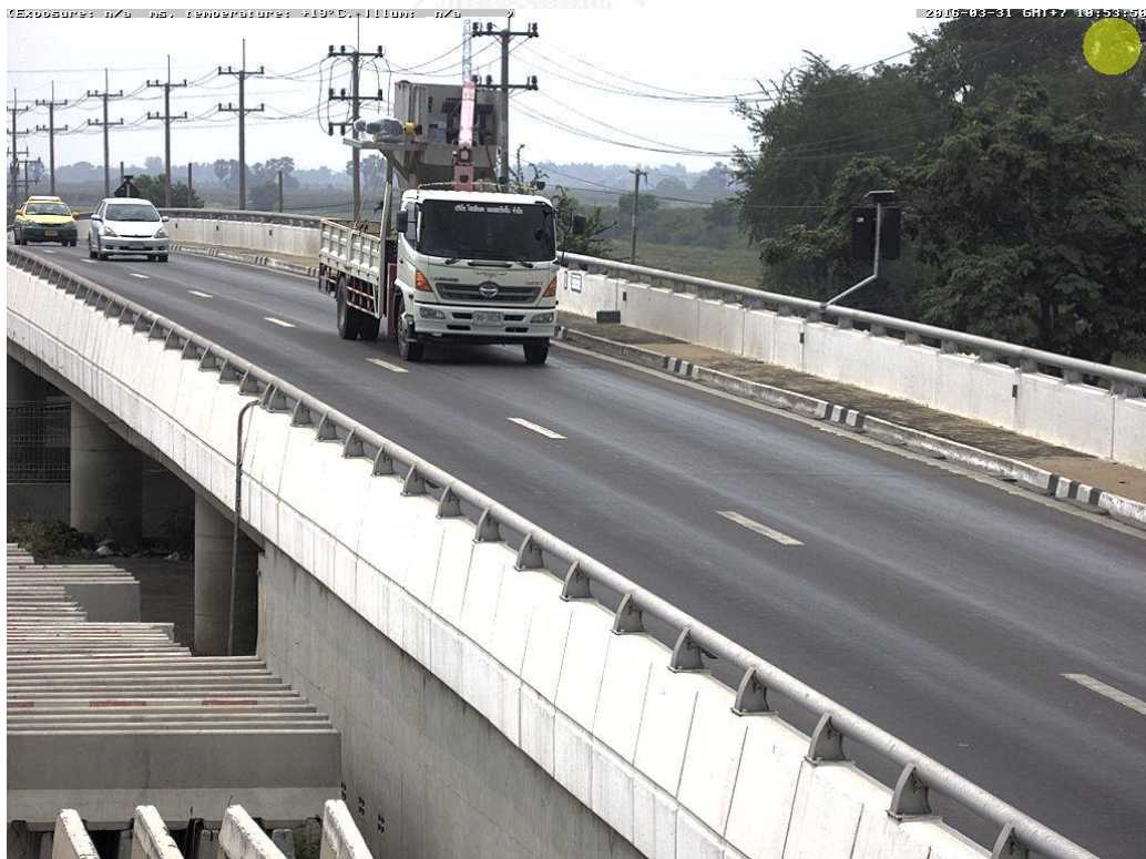
รูปที่ 5.50 รถบรรทุก 6 ล้อหนัก 11 ตัน วิ่งด้วยความเร็ว 58 กิโลเมตรต่อชั่วโมง
