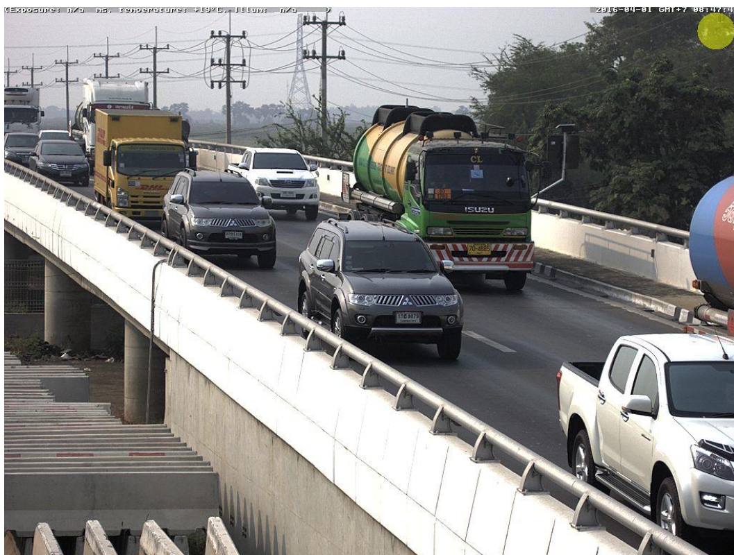
รูปที่ 5.12 รถบรรทุก 10 ล้อ หนัก 18.5 ตัน วิ่งด้วยความเร็ว 24 กิโลเมตรต่อชั่วโมง
