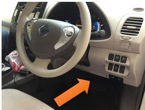
รูปที่ 14 ตำแหน่งติดตั้งอุปกรณ์อ่านข้อมูล
