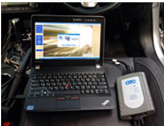
รูปที่ 11 ลักษณะการติดตั้งอุปกรณ์เก็บข้อมูลในรถยนต์สันดาปภายใน
