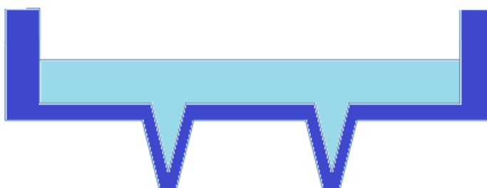
รูปที่ 3. 3 เข็มฉีดยาขนาดจุลภาคประเภทกลวงส่วนฐาน
