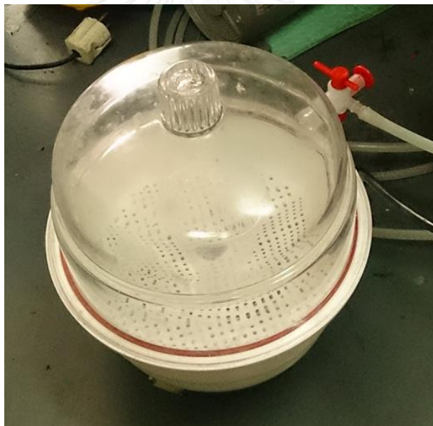
รูปที่ 4. 16 การ vacuum ใน chamber เพื่อกำจัดฟองอากาศ
