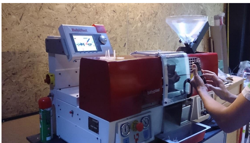
รูปที่ 4. 19 เครื่องสำหรับการ injection molding
