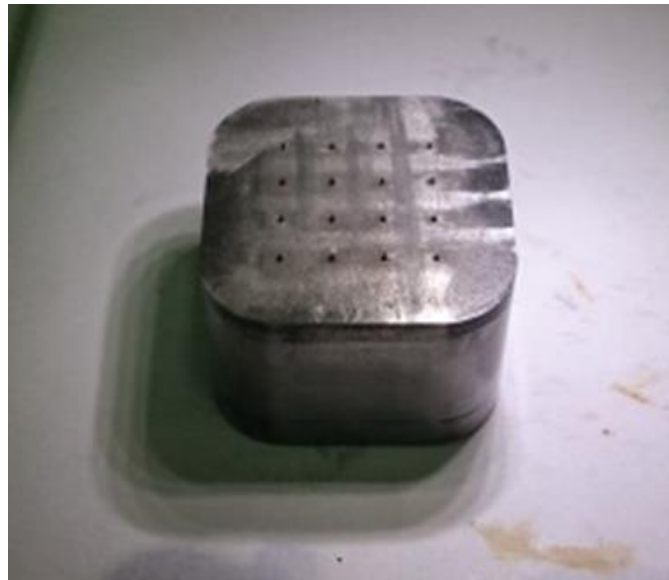
รูปที่ 4. 7 สแตนเลสสำหรับประกอบบนแม่พิมพ์สำหรับหล่อแม่พิมพ์ตัวเมีย
