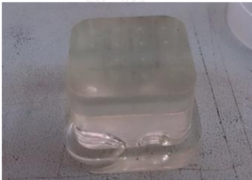
รูปที่ 4. 11 แม่พิมพ์ epoxy หลังการใช้งาน
