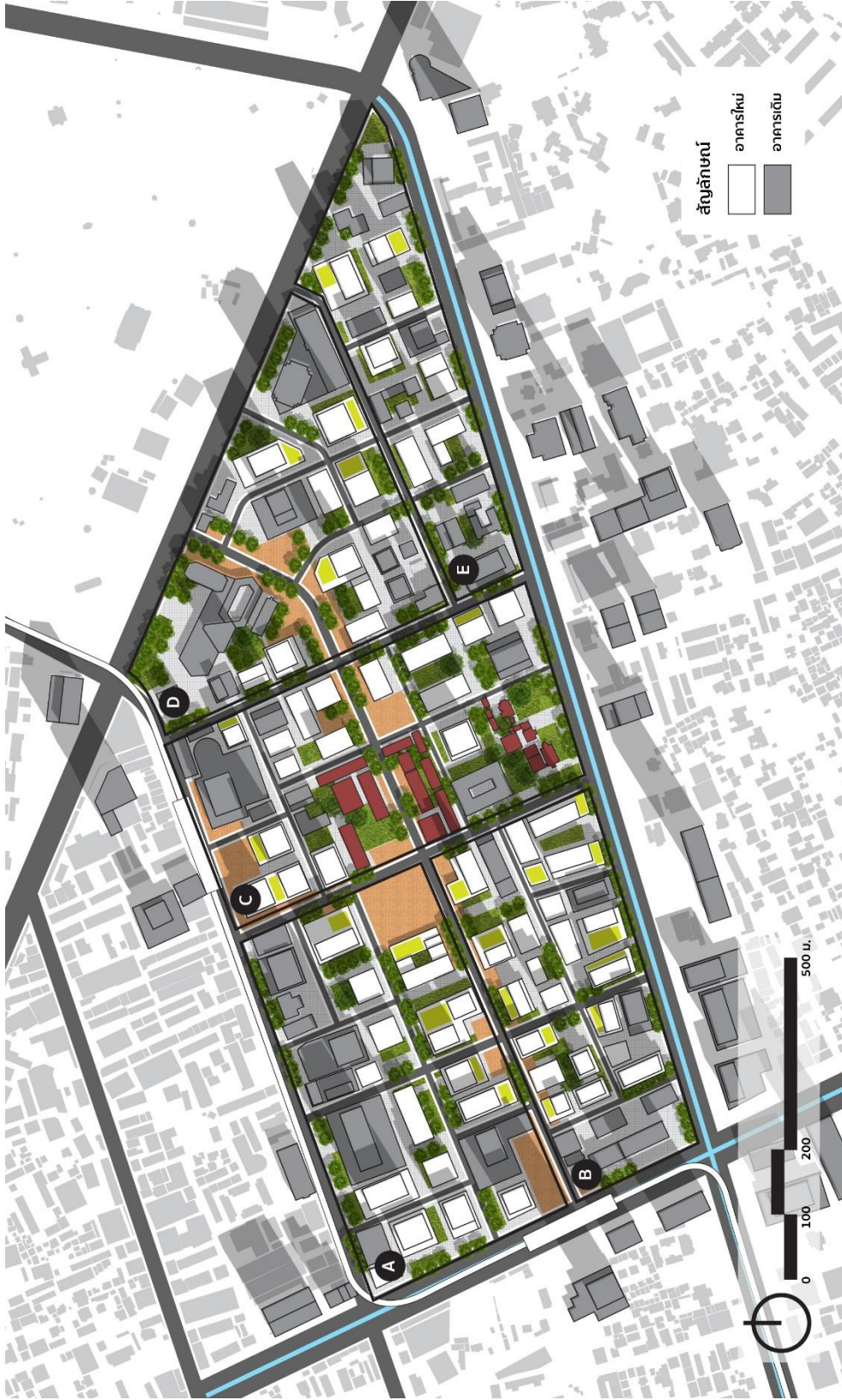
ภาพที่ 7-6 ผังแม่บทการจัดวางกลุ่มอาคารเพื่อการประหยัดพลังงานและลดการปล่อยคาร์บอนพื้นที่ศึกษาศูนย์กลางธุรกิจและพาณิชยกรรม สีลม-สาทร
