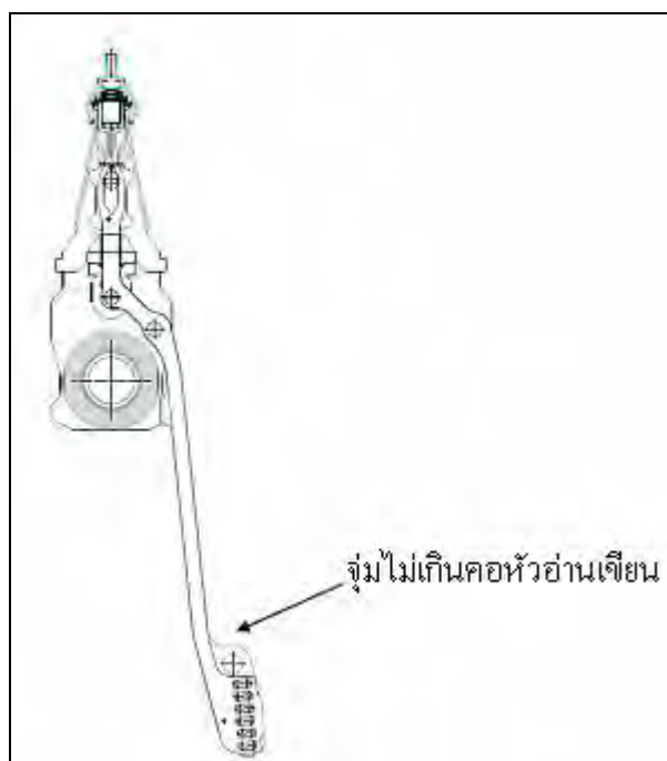
รูปที่ 3.14 กำหนดการจุ่มชุดหัวอ่านเขียนในน้ำยาไม่เกินคอหัวอ่านเขียน
