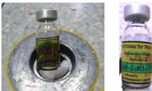
รูปที่ 3.3 ลักษณะภาชนะบรรจุแบบขวดแก้ว (Vial)
