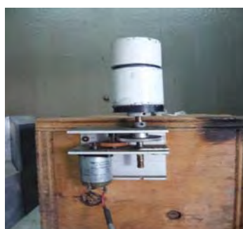
รูปที่ ก-3 การตรวจสอบความแรงรังสีเบื้องต้นจากเครื่องโคสคาไลเบรเตอร์ของ ศูนย์ไอโซโทปรังสี สถาบันเทคโนโลยีนิวเคลียร์แห่งชาติ(องค์การมหาชน) ซึ่งผ่านการสอบเทียบมาตรฐานจากห้องปฏิบัติการมาตรฐานด้านกัมมันตภาพรังสีและสารอ้างอิงรังสี ปส.
