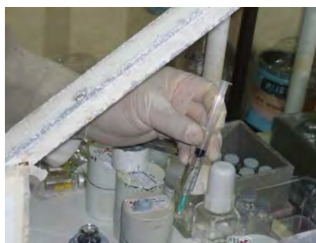
รูปที่ ก-2 การแบ่งสารรังสี ^{131}\text{I} ในภาชนะที่จัดเตรียมไว้ ซึ่งทำในตู้ควัน (Fume Hood) ของ ศูนย์ไอโซโทปรังสี สถาบันเทคโนโลยีนิวเคลียร์แห่งชาติ (องค์การมหาชน) โดยได้รับความช่วยเหลือจากเจ้าหน้าที่ ศูนย์ไอโซโทปรังสี สถาบันเทคโนโลยีนิวเคลียร์แห่งชาติ(องค์การมหาชน)
