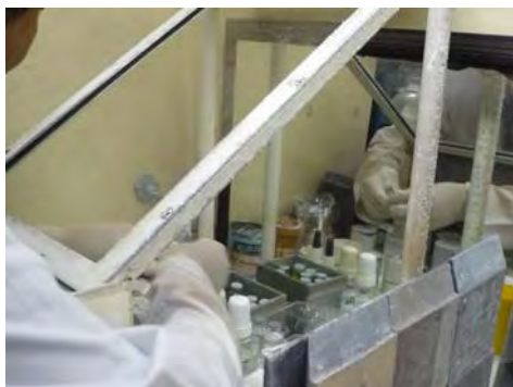
รูปที่ ก-2 การแบ่งสารรังสี ^{131}\text{I} ในภาชนะที่จัดเตรียมไว้ ซึ่งทำในตู้ควัน (Fume Hood) ของ ศูนย์ไอโซโทปรังสี สถาบันเทคโนโลยีนิวเคลียร์แห่งชาติ (องค์การมหาชน) โดยได้รับความช่วยเหลือจากเจ้าหน้าที่ ศูนย์ไอโซโทปรังสี สถาบันเทคโนโลยีนิวเคลียร์แห่งชาติ(องค์การมหาชน)
