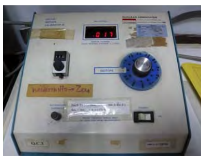
รูปที่ ก-3 การตรวจสอบความแรงรังสีเบื้องต้นจากเครื่องโคสคาไลเบรเตอร์ของ ศูนย์ไอโซโทปรังสี สถาบันเทคโนโลยีนิวเคลียร์แห่งชาติ(องค์การมหาชน) ซึ่งผ่านการสอบเทียบมาตรฐานจากห้องปฏิบัติการมาตรฐานด้านกัมมันตภาพรังสีและสารอ้างอิงรังสี ปส.
