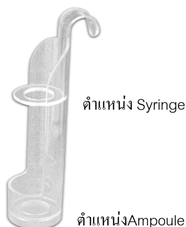
รูปที่ 3.6 ตำแหน่งการจัดวางสารตัวอย่างรังสีจาก Sample Holder ของเครื่องวัดฯ ตราสินค้า A
