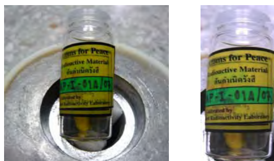
รูปที่ 3.5 ลักษณะภาชนะบรรจุแบบแคปซูล (Capsule)
