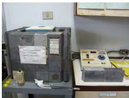
รูปที่ ก-3 การตรวจสอบความแรงรังสีเบื้องต้นจากเครื่องโคสคาไลเบรเตอร์ของ ศูนย์ไอโซโทปรังสี สถาบันเทคโนโลยีนิวเคลียร์แห่งชาติ(องค์การมหาชน) ซึ่งผ่านการสอบเทียบมาตรฐานจากห้องปฏิบัติการมาตรฐานด้านกัมมันตภาพรังสีและสารอ้างอิงรังสี ปส.
