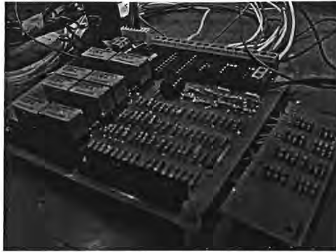
รูปที่ 7.2 บอร์ดวงจรไฟฟ้า และ ไอซี 3D-display
