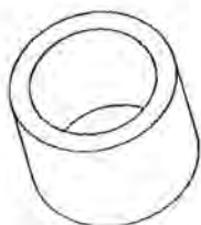
รูปที่ 5.13 รูปตัวป้องกันสนามแม่เหล็กของแม่เหล็กถาวร
