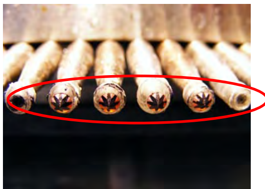
รูปที่ 8.17 เหลี่ยมพลอย Standard Round Brilliant ที่เกิดขึ้นเมื่อเจียรระไนด้านล่างของพลอย (Pavilion Side)
