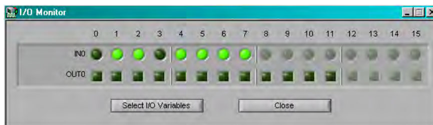
รูปที่ 2.10 หน้าต่างของโปรแกรมสำเร็จรูปที่ใช้ในการควบคุมอุปกรณ์ที่ต่อผ่าน Digital IO
