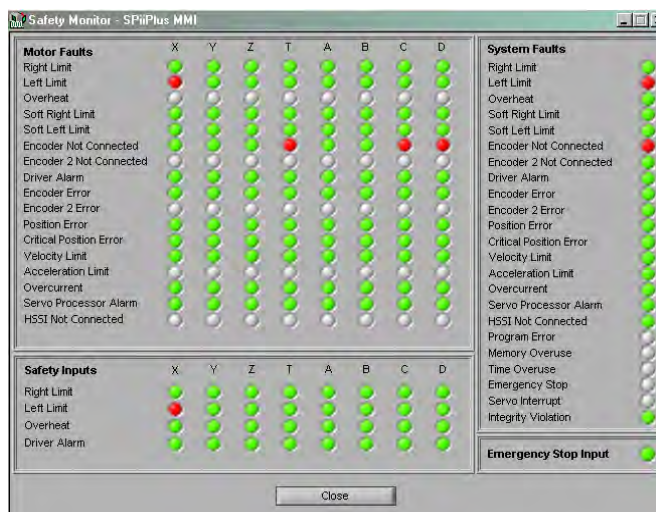
รูปที่ 2.12 หน้าต่างของโปรแกรมสำเร็จรูปที่ใช้ในการแสดงสถานะของเครื่อง (Safety monitor)
