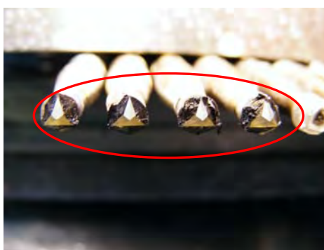
รูปที่ 8.22 เหลี่ยมพลอย Four Triangles ที่เกิดขึ้นเมื่อเจียระไนด้านล่างของพลอย (Pavilion Side)
