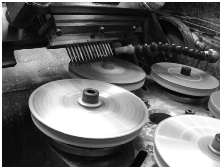
รูปที่ 7.10 การเจียระไนด้วยเครื่องเจียระไนพลอยจุฬาแบบอัตโนมัติ
