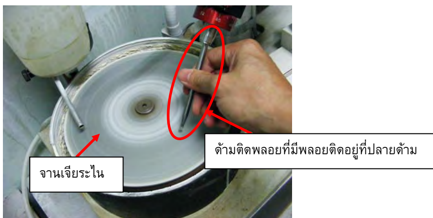
รูปที่ 7.7 การขึ้นรูปพอลอยให้ได้องศาด้วยเครื่องเจียรไนแบบใช้มือ
