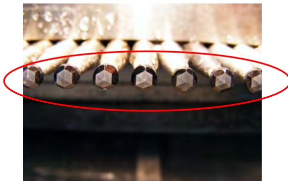
รูปที่ 8.21 เหลี่ยมพลอย Four Triangles ที่เกิดขึ้นเมื่อเจียระไนด้านบนของพลอย (Crown Side)
