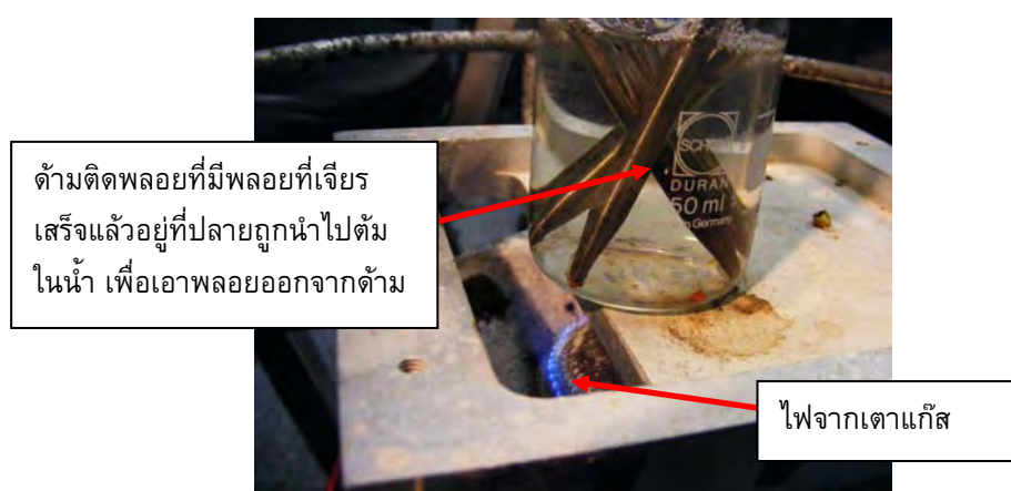
รูปที่ 7.17 การต้มด้ามติดพลอยเพื่อแกะพลอยออกจากด้าม
