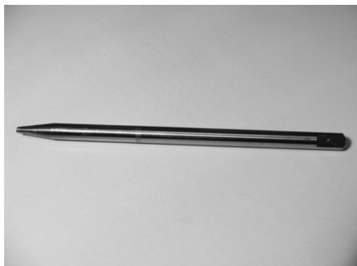
รูปที่ 5.7 ลักษณะของด้ามตีดพลอยที่มีการทำตำแหน่งอ้างอิงไว้ที่ปลายด้าม
