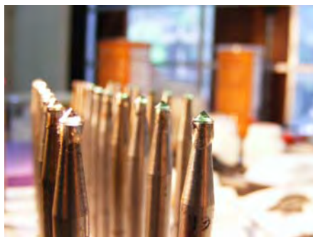
รูปที่ 7.16 พลอยที่ผ่านการเจียรระโนทั้งสองด้านแล้ว
