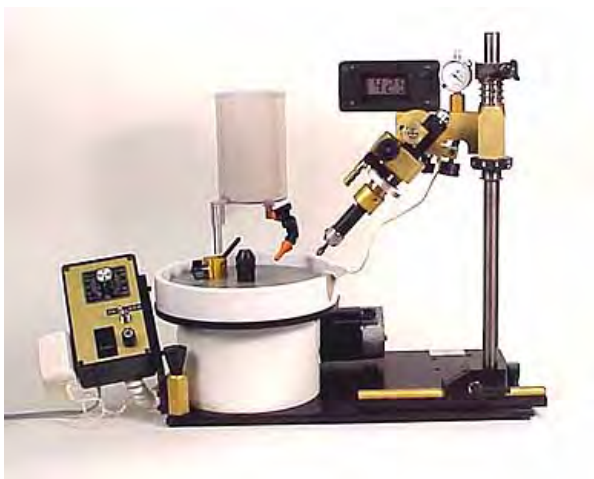
รูปที่ 2.3 เครื่องเจียรระไนพลอยของ Xristal [5]
