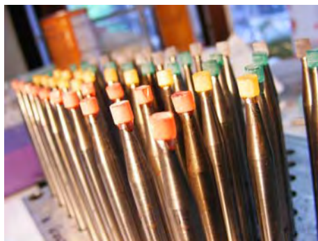
รูปที่ 7.5 การติดพอลอยที่เข้ากับด้ามติดพอลอย
