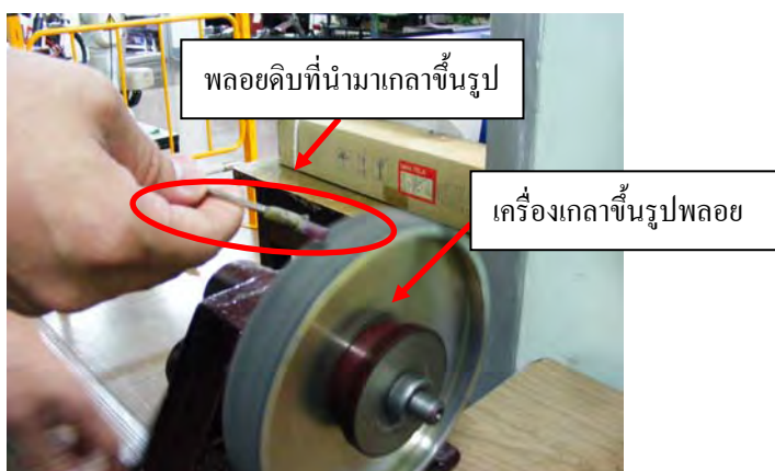
รูปที่ 7.3 การเกลารูปพลอยด้วยเครื่องเกลามือ
