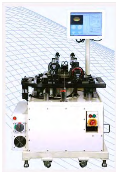
รูปที่ 2.5 เครื่องเจียรระโนพลอยอัตโนมัติ AD-Series
