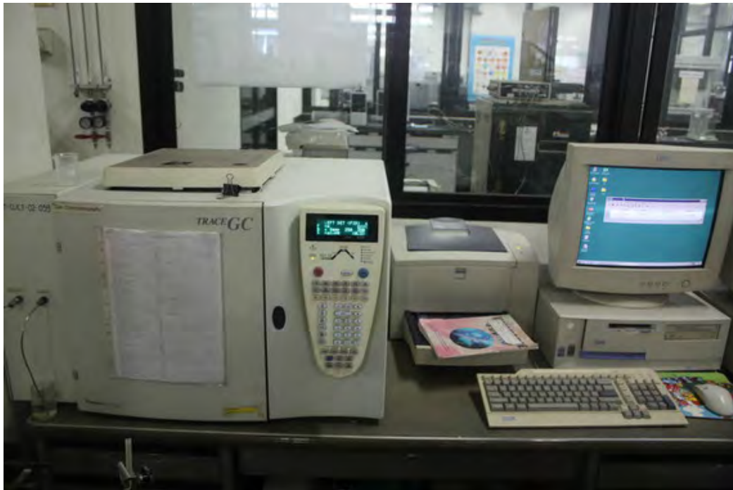
รูปที่ 3.7 เครื่องแก๊สโครมาโทกราฟี (GC) ยี่ห้อ Thermo Finnigan รุ่น Trace GC
