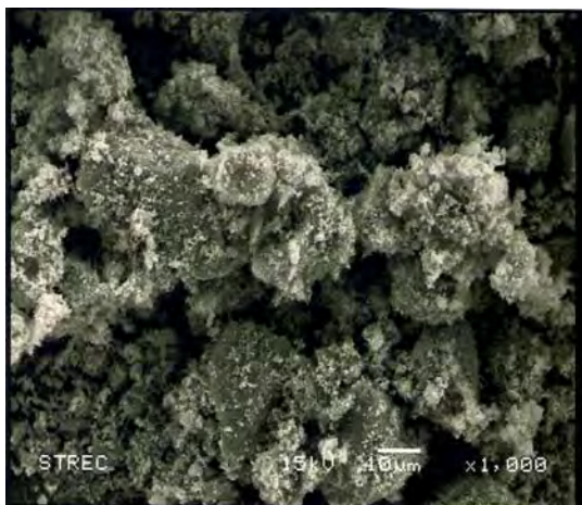
รูปที่ 4.4 ภาพถ่าย SEM ของตัวเร่งปฏิกิริยาเชิงแสงไทเทเนียมไดออกไซด์ที่โหลดด้วยซิลเวอร์ซึ่งเตรียมด้วยวิธี impregnation ที่กำลังขยาย (ก) 1000 และ (ข) 5000 เท่า
