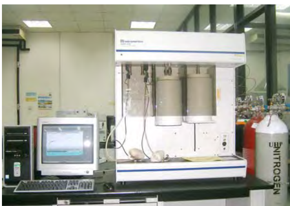
รูปที่ 3 เครื่อง Surface area and porosity analyzer รุ่น ASAP 2020 ยี่ห้อ Micromeritic
