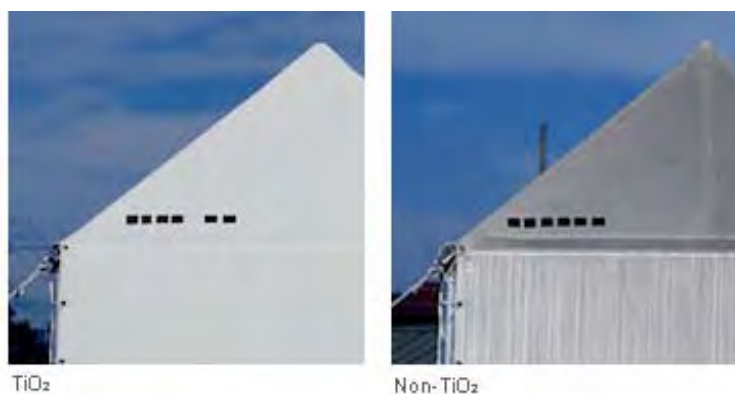
รูปที่ 2.9 ตัวอย่างการใช้ไทเทเนียมไดออกไซด์ที่มีสมบัติโฟโตคะตะลิสต์ทางด้าน Self-cleaning
