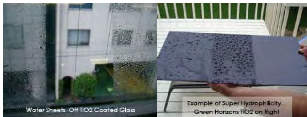
รูปที่ 2.10 ตัวอย่างการใช้ไทเทเนียมไดออกไซด์ที่มีสมบัติโฟโตคะตะลิสต์ทางด้าน Anti-fogging [12]
