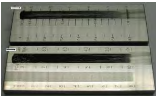
รูปที่ 3.3 เครื่องวัดความละเอียดวางในแนวนอน
