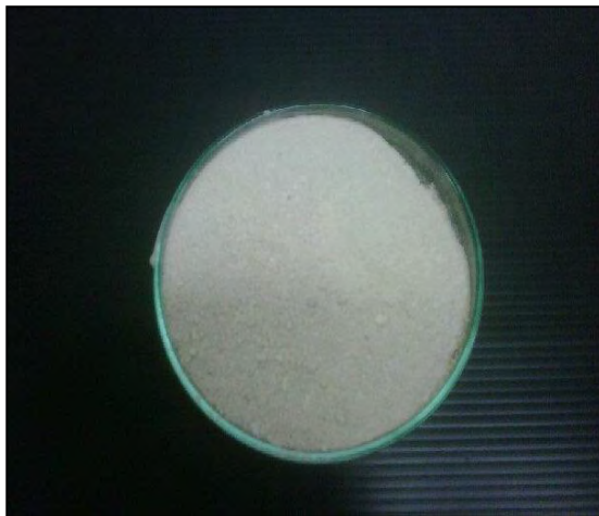
รูปที่ 3.5 ผงผลพลอยได้จากการผลิตกรดแล็กติก
