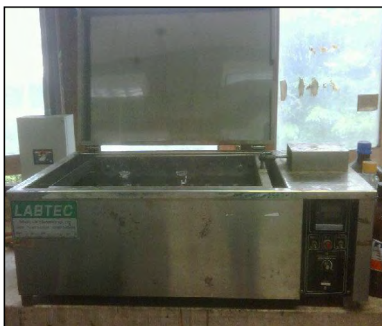
รูปที่ 3.6 เครื่องเขย่าแบบอ่างน้ำ รุ่น Labtec
