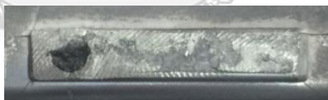
รูปที่ 3.11 ตัวอย่างของเสียประเภทสิ่งปลอมปนที่เกตชิ้นงาน
