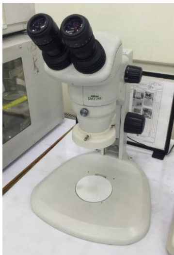
รูปที่ 3.5 กล้องเลนส์ขยายที่กำลังขยาย 10 เท่า
