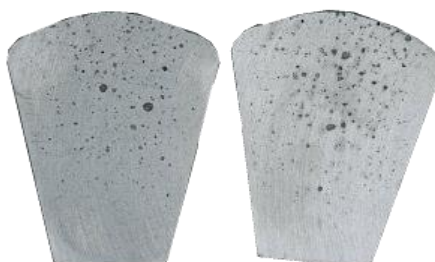
รูปที่ 3.10 ตัวอย่างชิ้นงานตรวจสอบแก๊สไฮโดรเจน (H 2 )
