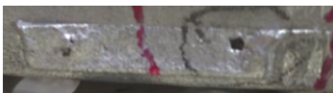
รูปที่ 3.12 ตัวอย่างของเสียประเภทโพรงอากาศที่บริเวณเกตชิ้นงาน
