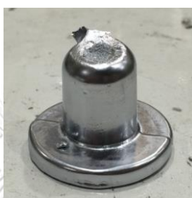
รูปที่ 3.7 ตัวอย่างชิ้นงานตรวจสอบองค์ประกอบของธาตุแมกนีเซียม (Mg)
