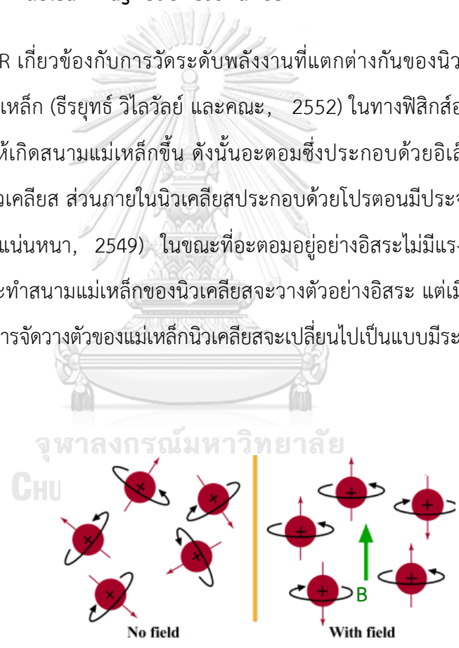
ภาพที่ 2.12 การจัดวางตัวของสนามแม่เหล็กของนิวเคลียสระหว่างไม่มีสนามแม่เหล็กภายนอก B_0 (no field) กับ มีสนามแม่เหล็กภายนอก B_0 (with field) ที่มา: Ellis et al. (2012)
