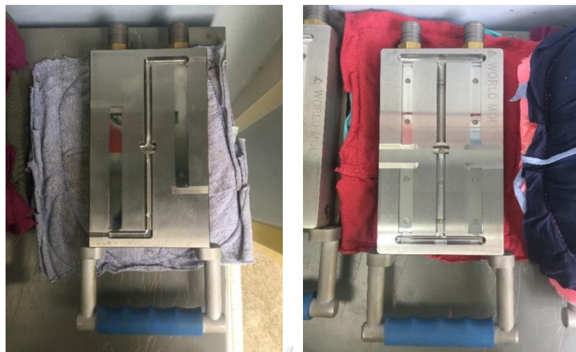
รูปที่ 3.8 แม่พิมพ์ที่ใช้ในการฉีดขึ้นรูปชิ้นงานเพื่อทดสอบสมบัติเชิงกล
