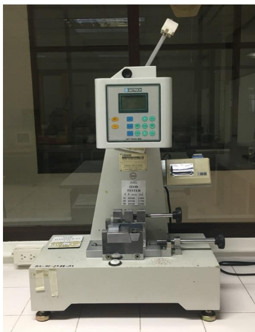
รูปที่ 3.10 เครื่องทดสอบแรงกระแทกแบบไอซอด
