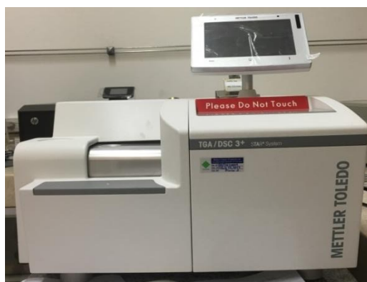
รูปที่ 3.16 เครื่องทดสอบสมบัติทางความร้อนด้วยเทคนิคดิฟเฟอเรนเชียลสแกนนิ่งแคลอริเมทรี
