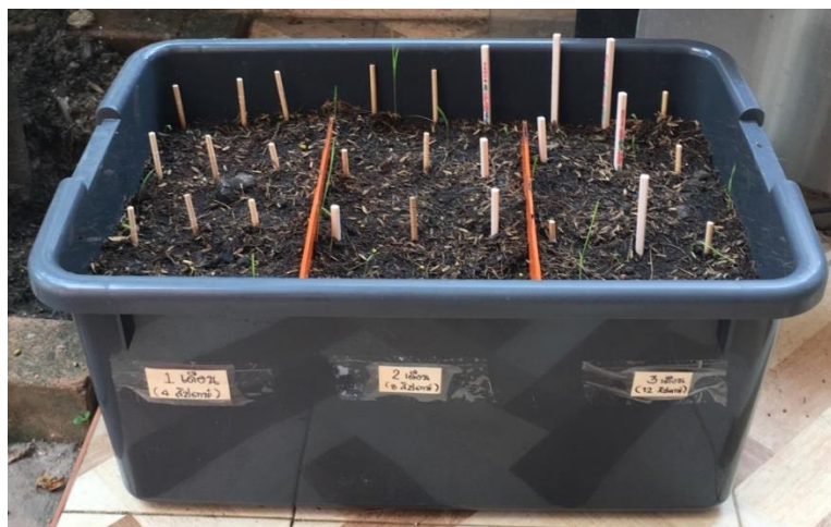
รูปที่ 3.15 กล่องทดสอบการย่อยสลายชิ้นงานพอลิแล็กติกแอซิดและพอลิแล็กติกแอซิดคอมพอสิตผสมตัวเติมไฮบริดสตาร์ซ/นาโนซิลิกาโดยการฝังดินในสถานะฝังกลบโดยทำการทดสอบเป็นระยะเวลา 4 สัปดาห์, 8 สัปดาห์ และ 12 สัปดาห์ ตามลำดับ
