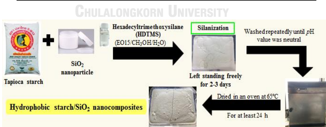
รูปที่ 3.3 ขั้นตอนการเตรียมตัวเติมไฮบริดสตาร์ช/นาโนซิลิกา
