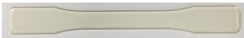
รูปที่ 3.11 ลักษณะชิ้นงานดัมเบลล์ที่นำมาทดสอบ
