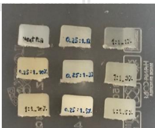
รูปที่ 4.9 ชิ้นงานพอลิแล็กติกแอซิดและพอลิแล็กติกแอซิดคอมพอสิตผสมตัวเต็มไฮบริดสตาร์ช/นาโนซิลิกาที่ 4 ST : 1 HDTMS และ 1 ST : 1 HDTMS ในปริมาณต่างกัน ไปแช่ในน้ำกลั่นเป็นระยะเวลา 600 ชั่วโมง หรือ 25 วัน
