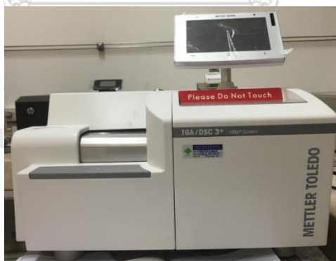
รูปที่ 3.17 เครื่องทดสอบสมบัติทางความร้อนและอุณหภูมิการสลายตัวด้วยเทอร์โมกราวิเมตริกแอนาไลเซอร์
