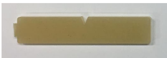
รูปที่ 3.9 ชิ้นงานตัวอย่างที่ใช้ในการทดสอบความทนแรงกระแทก
