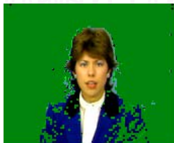
รูปที่ 3.11 ตัวอย่างมาสก์ที่ได้จากการตัดสินใจในรูปแบบของภาพสี
