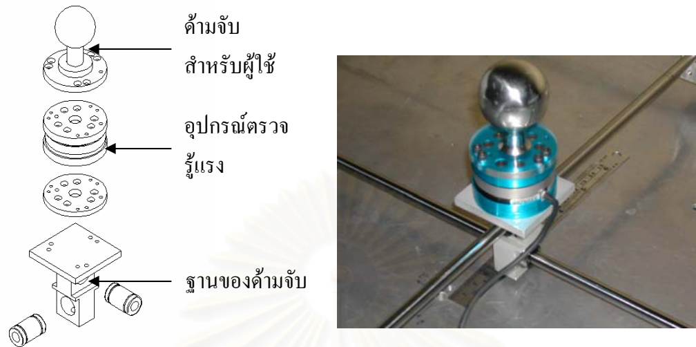
รูปที่ 5.2 อุปกรณ์วัดแรงที่ติดตั้งด้านบนของด้ามจับ
