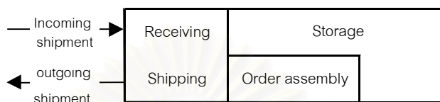
รูปที่ 2.4 การวางผังคลังให้จุดรับและจัดส่งใช้พื้นที่บริเวณเดียวกัน ที่มา: Smith (1989: 381)
