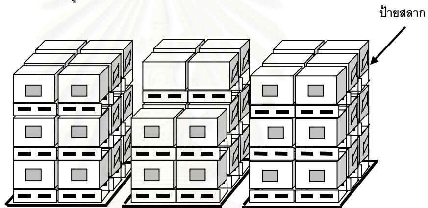
รูปที่ 4.23ก การจัดวางลังสินค้าบริเวณจัดเก็บบนพื้น
