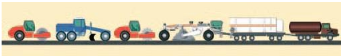
รูปที่ 2-2 เครื่องจักรที่ใช้ และลำดับของเครื่องจักร ในการผสมเยนแบบในที่ใช้ทั้ง ปูนซีเมนต์และบิทูเมนอิมัลชันเป็นสารปรับปรุงคุณภาพ (Wirtgen GmbH, 2010)
