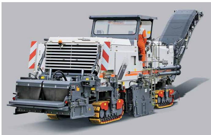
รูปที่ 3-1 เครื่องจักรรีไซเคิล ยี่ห้อ Wirtgen รุ่น 2200 CR (Wirtgen GmbH, 2008)
