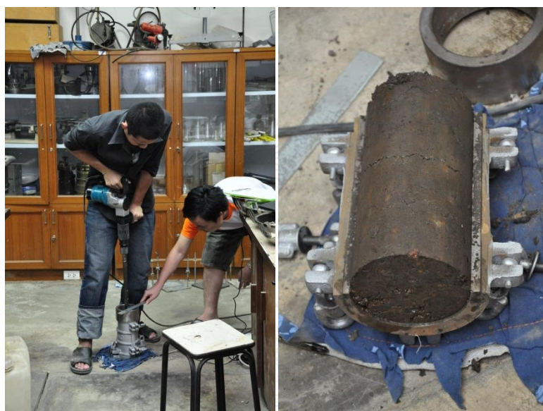
รูปที่ 4-37 (ซ้าย) แบบหล่อและการบดอัดเตรียมก้อนตัวอย่างขนาดเส้นผ่าศูนย์กลาง 100 มิลลิเมตร สูง 200 มิลลิเมตร (ขวา) ตัวอย่างที่บดอัดเรียบร้อยแล้ว กำลังถูกแกะออกจากแบบหล่อ
