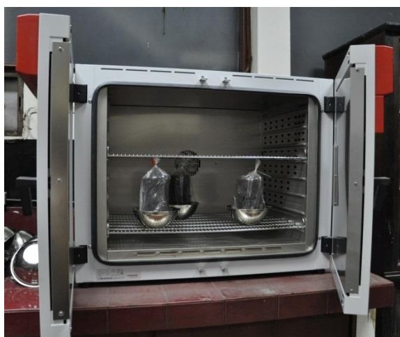
รูปที่ 4-38 การบ่มก้อนตัวอย่างเพื่อให้มีระดับความชื้นในชั้นพื้นทางตามธรรมชาติ
