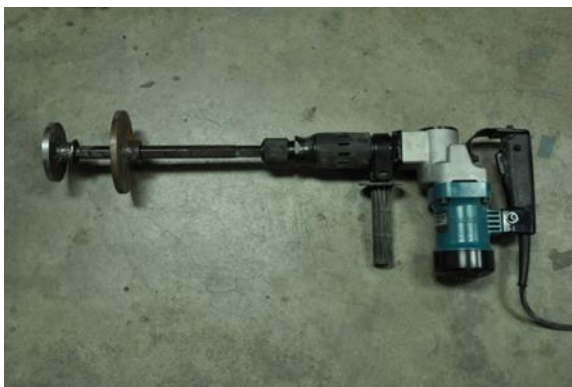
รูปที่ 3-3 Vibratory hammer ยี่ห้อ Makita รุ่น HM0810TA
