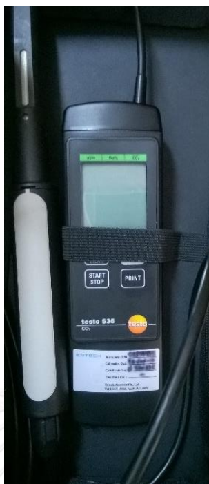
รูปที่ ก-9 CO 2 -meter
