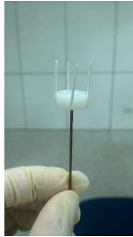
รูปที่ 3.4 การติดเมมเบรนบน Dataphysics PUR11- Tensiometry
