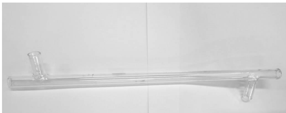
รูปที่ ก-5 โมเดลแก้วสำหรับบรรจุเส้นใยเมมเบรน
