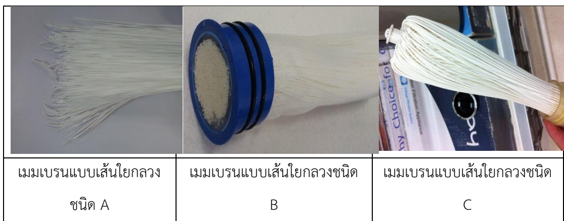
ตารางที่ 3.1 รูปภาพเมมเบรนชนิดเส้นใยกลวงรูปแบบต่างๆ
