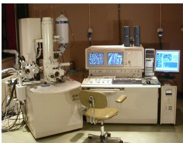
รูปที่ 3.4 เครื่อง Field emission scanning electron microscope ยี่ห้อ JEOL รุ่น JSM-6301F
