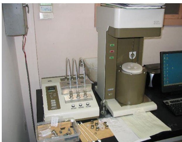
รูปที่ 3.9 เครื่อง Surface area and porosity analyzer ยี่ห้อ BEL Japan รุ่น Belsorp Mini
