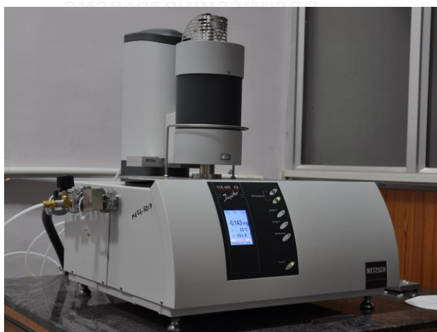
รูปที่ 3.1 เครื่อง Simultaneous thermal analyzer (STA) ยี่ห้อ NETZSCH รุ่น STA 449 F3
