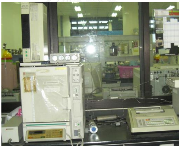
รูปที่ 3.13 เครื่องแก๊สโครมาโทกราฟียี่ห้อ Shimadzu รุ่น GC 14A สำหรับวิเคราะห์ FAME ที่ได้จากปฏิกิริยาทรานส์เอสเทอริฟิเคชันของน้ำมันปาล์มกับเมทานอล
