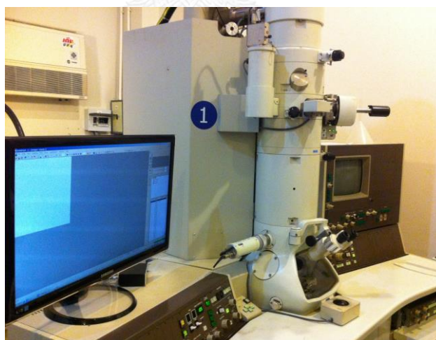
รูปที่ 3.5 เครื่อง Transmission electron microscope ยี่ห้อ JEOL รุ่น JEM-2010
