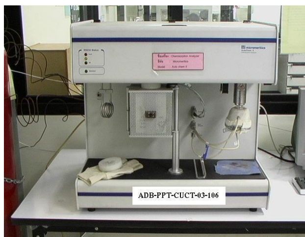
รูปที่ 3.10 เครื่อง Chemisorption analyzer ยี่ห้อ Micromeritics รุ่น AutoChem II 2920
