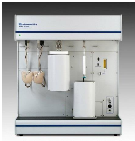
รูปที่ 3.11 เครื่อง Surface area and porosity analyzer ยี่ห้อ Micromeritics รุ่น ASAP 2020
