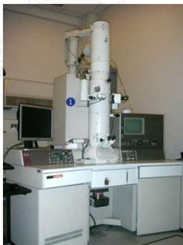
รูปที่ 3.8 กล้อง Transmission electron microscope ยี่ห้อ JEOL รุ่น JEM-2010
