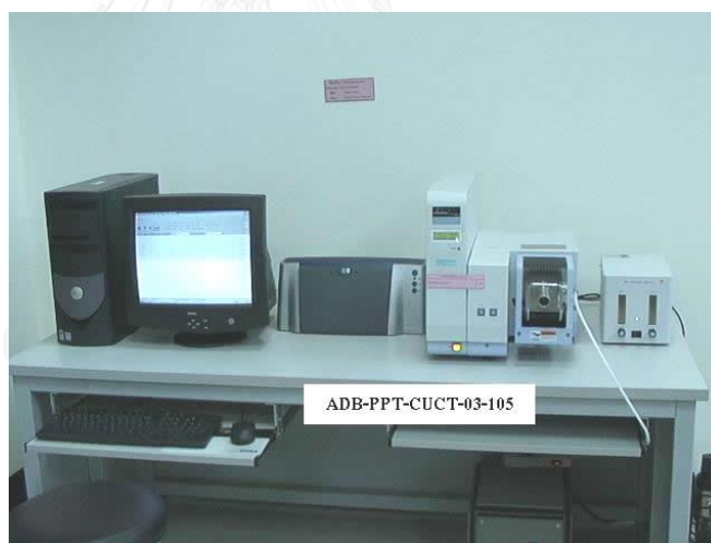
รูปที่ 3.9 เครื่อง Thermogravimetric/differential thermal analyzer ยี่ห้อ PerkinElmer รุ่น Pyris Diamond
