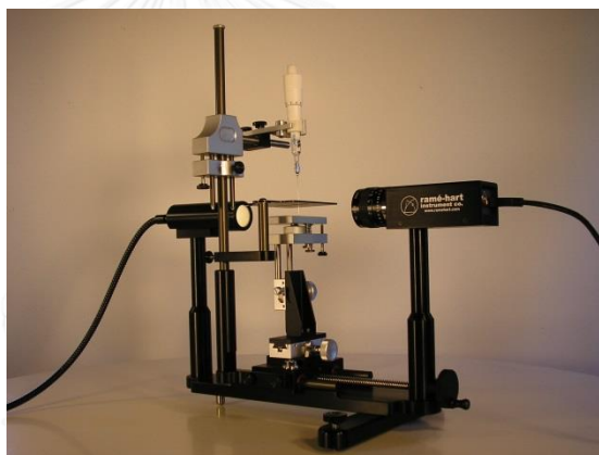
รูปที่ 3.14 เครื่องวัด contact angle measurement ยี่ห้อ Ramé-hart รุ่น Standard goniometer model 200-F1
