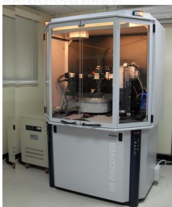
รูปที่ 3.6 เครื่อง X-ray diffractometer ยี่ห้อ Bruker รุ่น D8 Discover
