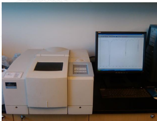
รูปที่ 3.10 เครื่อง Fourier transform infrared spectroscopes ยี่ห้อ PerkinElmer รุ่น Spectrum One
