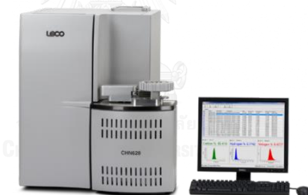
รูปที่ 3.12 เครื่อง CHNS/O elemental analyzer ยี่ห้อ LECO รุ่น LECO 628
