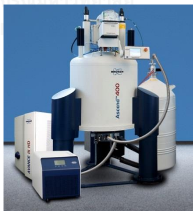
รูปที่ 3.13 เครื่อง Solid-state nuclear magnetic resonance spectrometer ยี่ห้อ Bruker รุ่น Ascend 400WB
