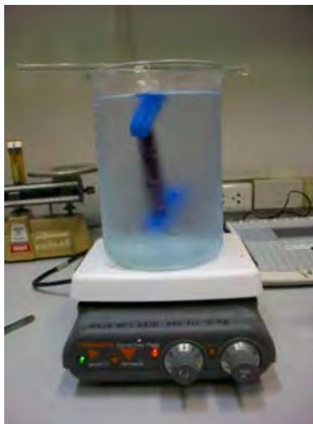
ภาพที่ 3.3 แสดงการทำ dialysis สารละลายตะกอนสีน้ำเงินเข้มในถุง dialysis membrane
