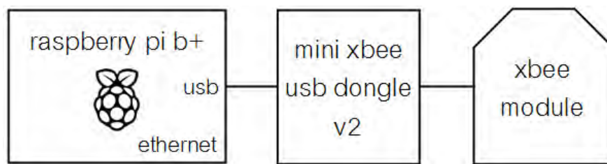
รูปที่ 3.3: แผนภาพบล็อกการเชื่อมต่ออุปกรณ์ของเกตเวย์
