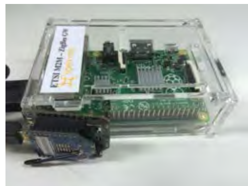
(b) ส่วนประกอบสำหรับทำหน้าที่เกตเวย์ของ ETSI M2M
