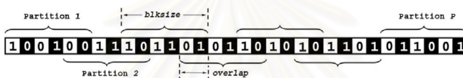
รูปที่ 3.4 การแบ่งเวกเตอร์ฐานสองออกเป็น P ส่วน โดยมีขนาดของแต่ละส่วนเท่ากับ l บิต และมีการซ้อนทับเท่ากับ k บิต ระหว่างส่วนที่อยู่ติดกัน
