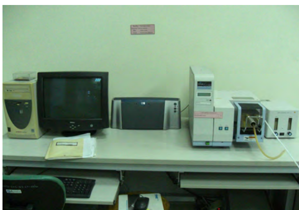
รูปที่ 3.4 เครื่อง Thermal analyzer รุ่น Pyris Diamond ของ Perkin Elmer
