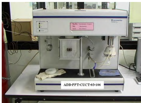
รูปที่ 3.5 เครื่อง Chemisorption analyzer รุ่น AutoChem II 2920 ของ Micromeritics
