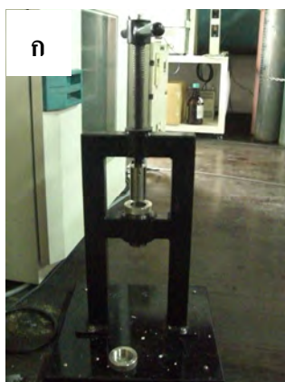
รูปที่ 3.1 อุปกรณ์อัดขึ้นรูปตัวเร่งปฏิกิริยา (ก) เครื่องอัดขึ้นรูป (ข) ชิ้นส่วนของเครื่องอัดขึ้นรูป
