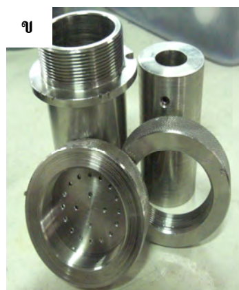
รูปที่ 3.1 อุปกรณ์อัดขึ้นรูปตัวเร่งปฏิกิริยา (ก) เครื่องอัดขึ้นรูป (ข) ชิ้นส่วนของเครื่องอัดขึ้นรูป
