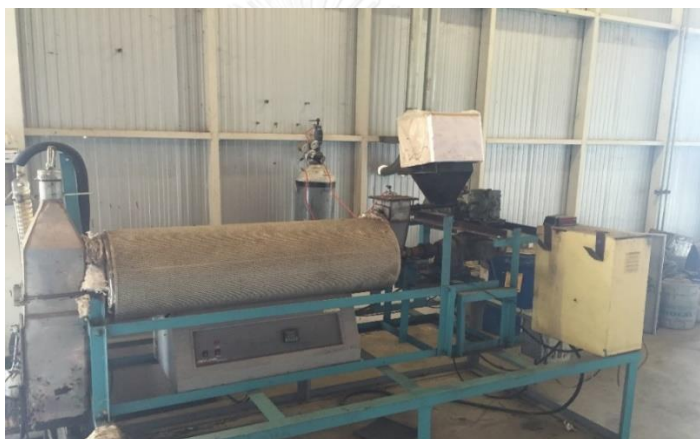
รูปที่ 3.2 เครื่องปฏิกรณ์ไพโรไลซิสแบบต่อเนื่อง
