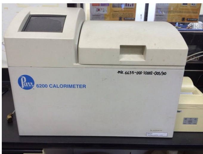
รูปที่ 3.6 เครื่องวิเคราะห์หาค่าความร้อนรุ่น Parr 6200 Calorimeter
