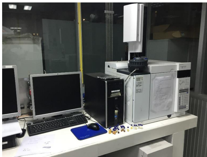
รูปที่ 3.7 เครื่องแก๊สโครมาโทกราฟี พร้อมซอฟต์แวร์แบบจำลองการกลั่น
