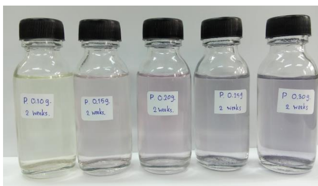
รูปที่ 4.7 สารละลายอนุภาคนาโนทองที่สังเคราะห์ด้วยไฮยาโนแบคทีเรียจากระบบน้ำหล่อเย็นในโรงงานที่มีอายุ 2 สัปดาห์เป็นตัวรีดิวซ์ ด้วยปริมาณ 0.10, 0.15, 0.20, 0.25, 0.30 กรัม (จากขวดซ้ายมาขวาตามลำดับ)
