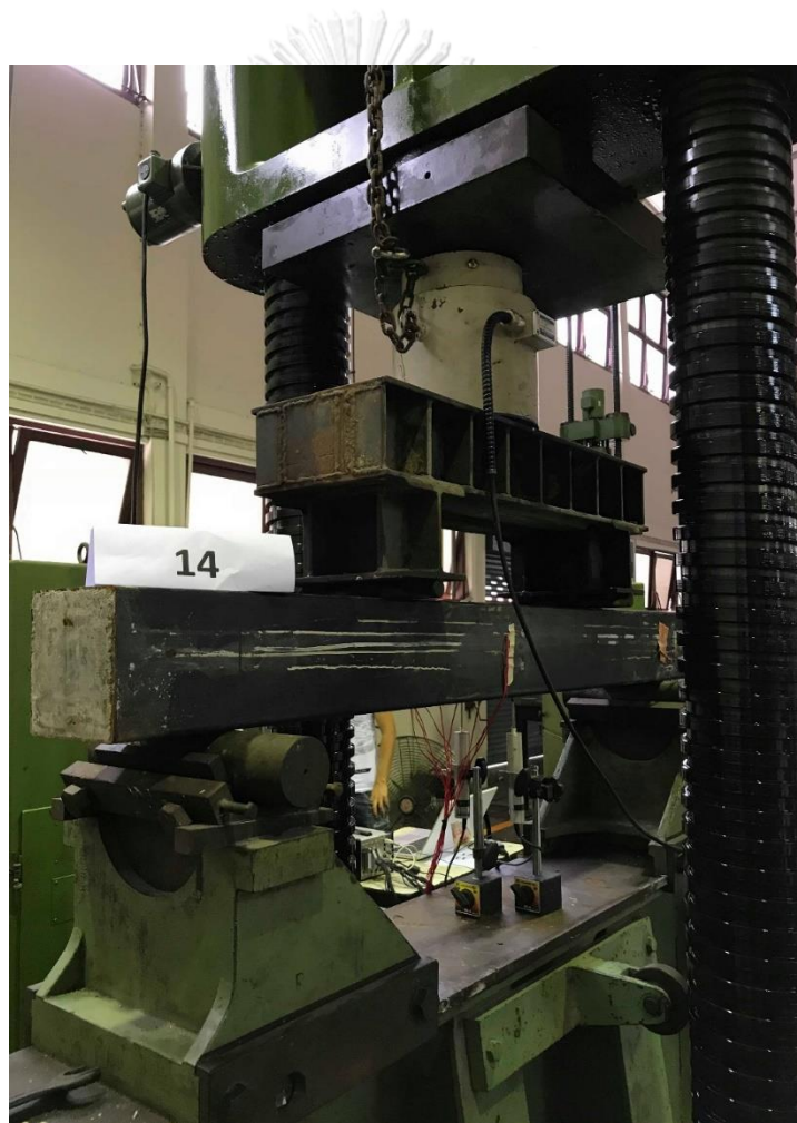
รูปที่ 4.18 การทดสอบตัวอย่างคานรับแรงดัด
