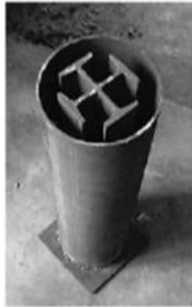
รูปที่ 2.2 การเชื่อมตัวอย่างทดสอบ (Wang และคณะ, 2004)
