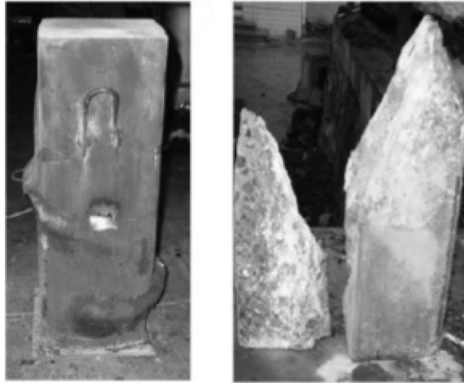
รูปที่ 2.12 การวิบัติของเสาดตัวอย่าง S4H (Zhu และคณะ, 2010)
