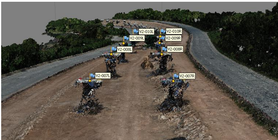
รูปที่ 6.20 แบบจำลองสภาพพื้นที่แสดงเส้นทางการทำงานของโครงเหล็กเลื่อน
