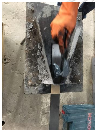
(ก) การทำอิพอกซีที่ CFRP
