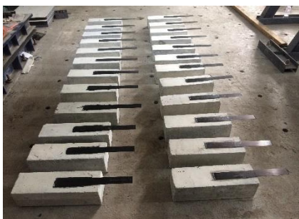
(ก) หลังจากการติดตั้ง CFRP
