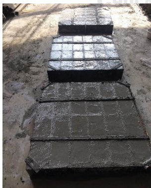
(ก) การหล่อคอนกรีตตัวอย่าง
