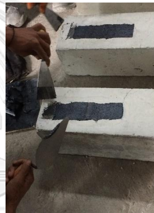
(ข) การทำอิพอกซีที่คอนกรีตตัวอย่าง
