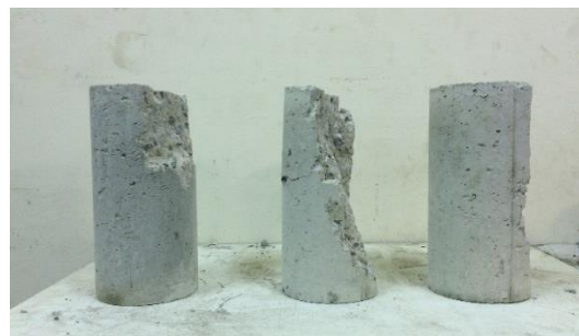
(ค) คอนกรีตตัวอย่างทรงกระบอกหลังการทดสอบ
