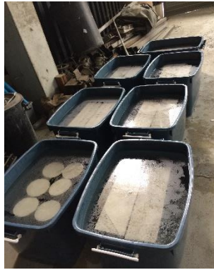
รูปที่ 3.5 การบ่มคอนกรีตตัวอย่างและคอนกรีตตัวอย่างทรงกระบอก
