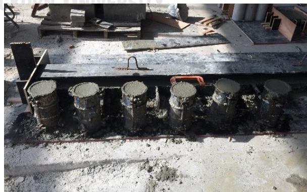
(ข) การหล่อคอนกรีตตัวอย่างทรงกระบอก
