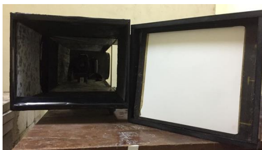
รูปที่ 3.6 กล้องทึบแสงสำหรับการถ่ายภาพด้วยรังสีประกอบด้วยฉากเรืองรังสี
