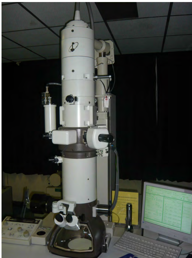
รูปที่ 3.9 เครื่อง Transmission Electron Microscope (TEM) รุ่น JEOL JEM-1230
