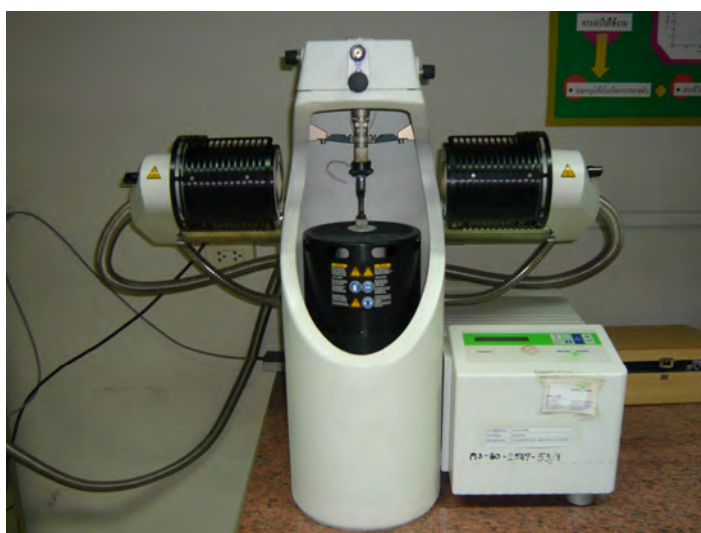
รูปที่ 3.20 เครื่อง Dynamic mechanical analyzer ของ METTLER TOLEDO รุ่น DMA/SDTA 861°
