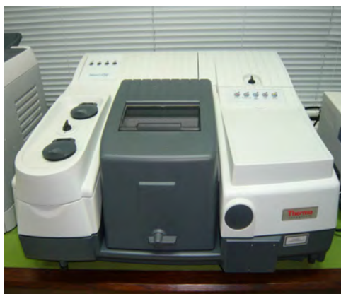
รูปที่ 3.1 เครื่อง Fourier Transform Infrared Spectrometer รุ่น FT-IR Nicolet 6700
