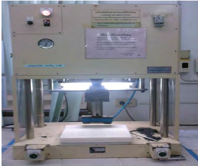
รูปที่ 3.14 เครื่องตัดชิ้นงาน compress air sample cutter รุ่น SDAP-100-N
