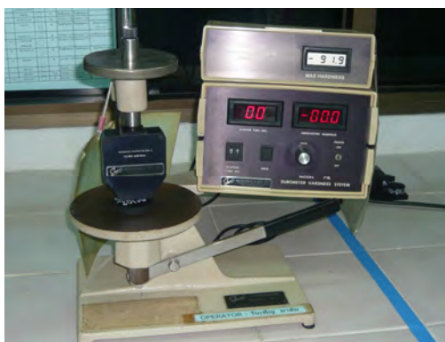
รูปที่ 3.18 เครื่องทดสอบความแข็งแบบ Shore A durometer hardness system
