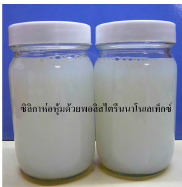
รูปที่ 4.1 นาโนเลเท็กซ์ของซิลิกาห่อหุ้มด้วยพอลิสไตรีนที่สังเคราะห์จากกระบวนการเกิดพอลิเมอร์แบบ 'อินซิทู' ดิฟเฟอเรนเชียลไมโครอิมัลชัน
