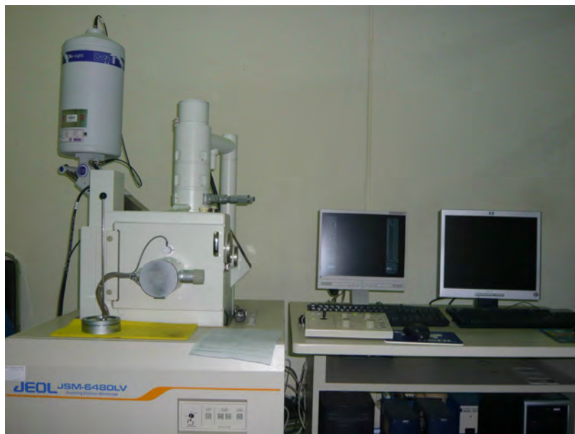
รูปที่ 3.21 เครื่อง Scanning electron microscope รุ่น JEOL JSM-6480 LV
