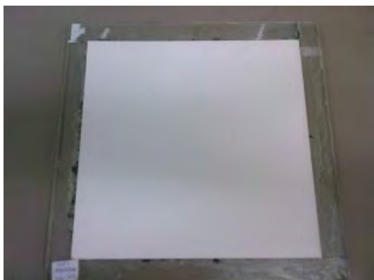
รูปที่ 3.12 แม่พิมพ์ที่ทำจากแผ่นกระจกขนาด 20 \times 20 \times 0.15 เซนติเมตร
