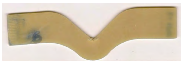
รูปที่ 3.16 ชิ้นทดสอบแบบ Angle สำหรับทดสอบความทนการฉีกขาด
