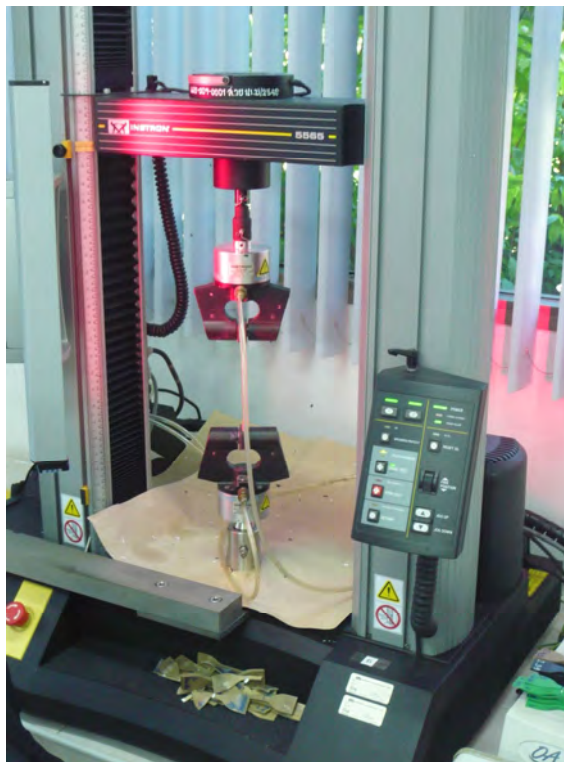
รูปที่ 3.15 เครื่อง Instron Testing Machine รุ่น Instron IX-1011
