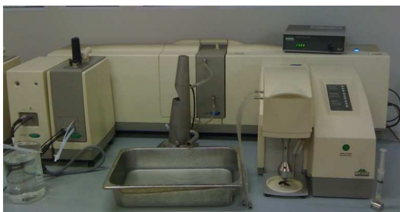
รูปที่ 3.8 เครื่อง LPSDA ที่ใช้ในการวิเคราะห์ขนาดของไมโครแคปซูล
