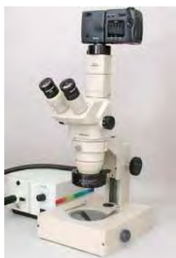
รูปที่ 3.7 เครื่อง OM (ซ้าย) และ SEM (ขวา) ที่ใช้ในการวิเคราะห์สัณฐานวิทยาของไมโครแคปซูล
