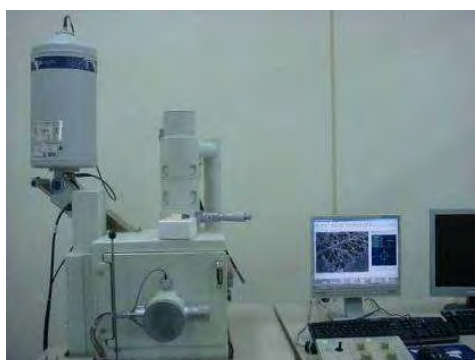
รูปที่ 3.7 เครื่อง OM (ซ้าย) และ SEM (ขวา) ที่ใช้ในการวิเคราะห์สัณฐานวิทยาของไมโครแคปซูล
