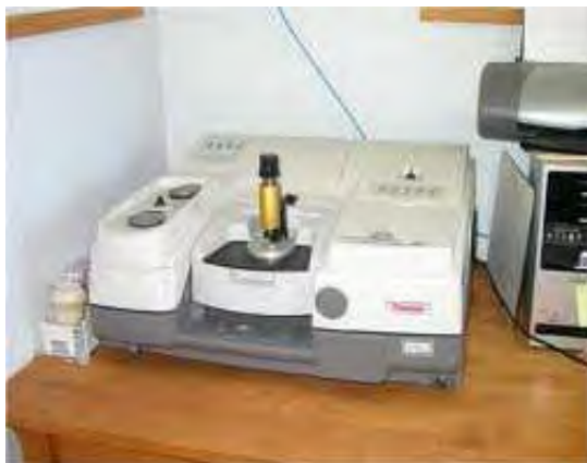
รูปที่ 3.6 เครื่อง FTIR ที่ใช้ในการวิเคราะห์โครงสร้างทางเคมีของไมโครแคปซูล น้ำมันหอมระเหยชา เม็ด แอลจินเตและเม็ดพอลิยูรีเทน-ยูเรีย
