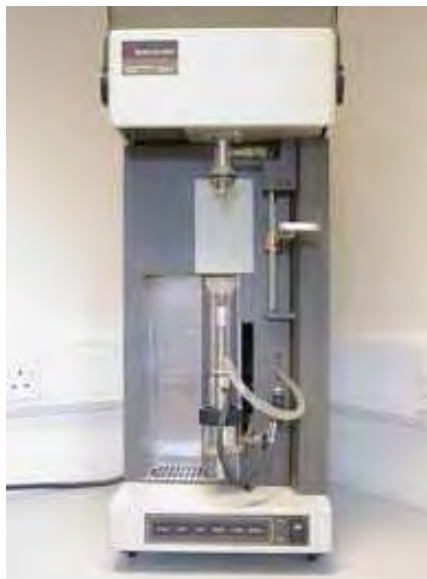
รูปที่ 3.9 เครื่อง TGA ที่ใช้ในการวิเคราะห์สมบัติทางความร้อน
