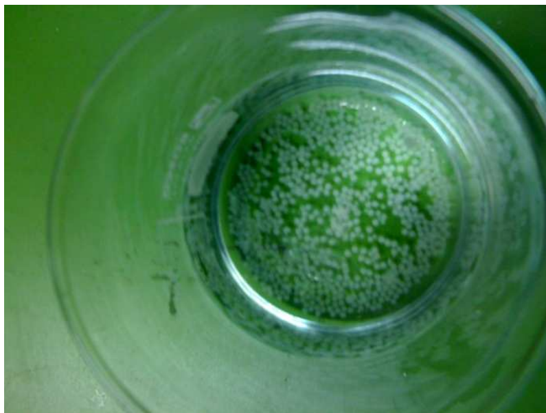
รูปที่ 3.4 ไมโครแคปซูลน้ำมันหอมระเหยซ่า/แอลจีเนตที่เตรียมได้โดยวิธี Orifice
