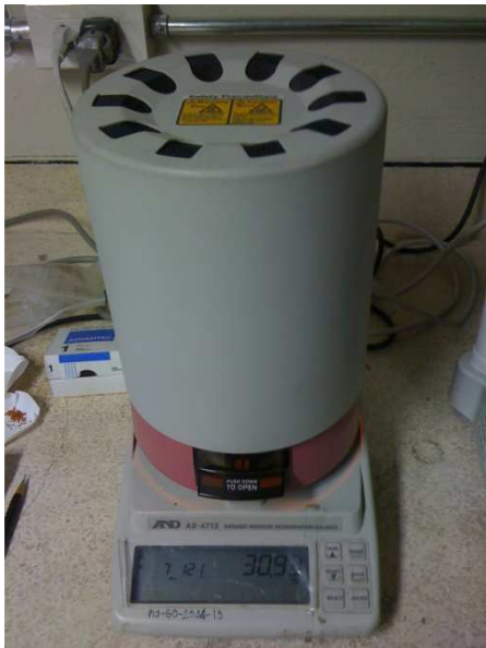
รูปที่ 3.10 เครื่องวัดปริมาณความชื้น (IMDB) ที่ใช้ในการหาปริมาณน้ำมันหอมระเหยจากไม้โครแคปซูล
