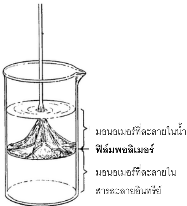
รูปที่ 2.7 การสังเคราะห์พอลิเมอร์แบบอินเตอร์เฟเชียลพอลิเมอไรเซชัน [26]
