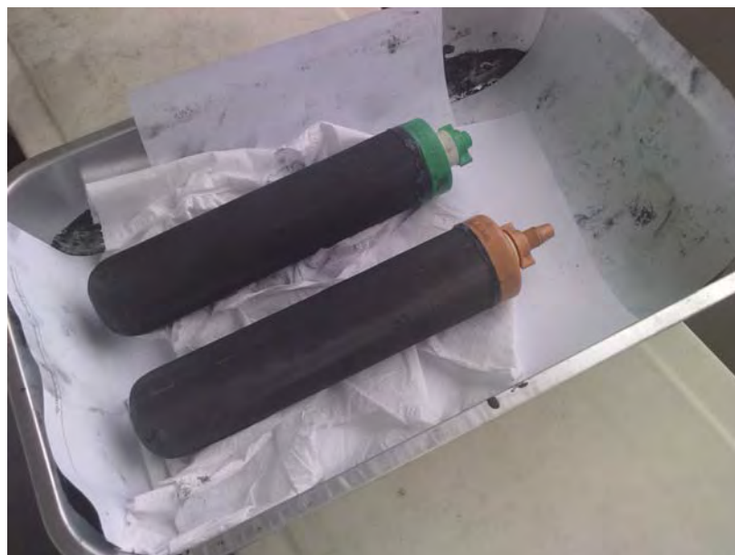
รูปที่ 4.12 ชิ้นงานไส้กรองน้ำถ่านแกลบกัมมันต์ หลังเผาและซีดประกอบกับฝาพลาสติก
