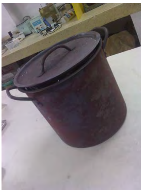
รูปที่ 3.8 ภาชนะหม้อสแตนเลสที่ใช้บรรจุชิ้นงานในการเผา
