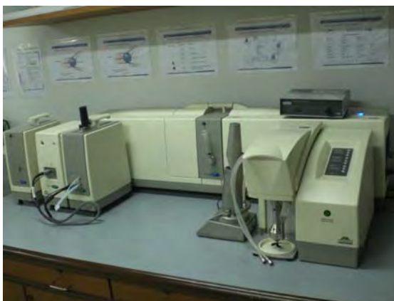
รูปที่ 3.14 เครื่อง Particle size analyzer PSD (Mastersizer 2000 Ver 2.19, Malvern)
