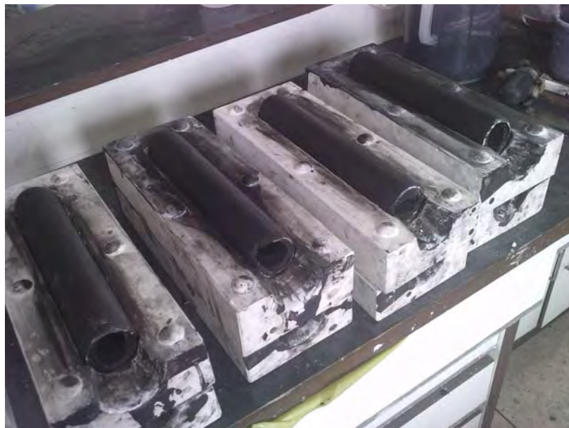
รูปที่ 4.10 ชิ้นงานไส้กรองน้ำถ่านแกลบในแม่พิมพ์ปูนพลาสติก
