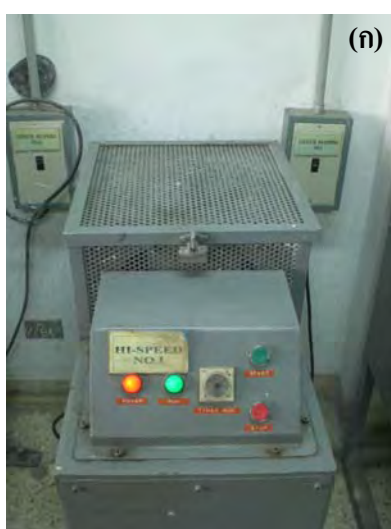
รูปที่ 3.5 เครื่องบดแบบเหวี่ยงเป็นวงความเร็วสูง (ก) และหม้อบดปอร์ซเลน (ข)
