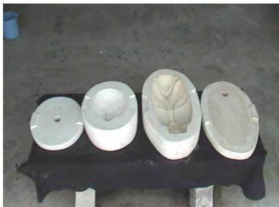
รูปที่ 2.5 แม่พิมพ์ที่ผ่านการเช็ดทำความสะอาดก่อนหล่อน้ำดิน
