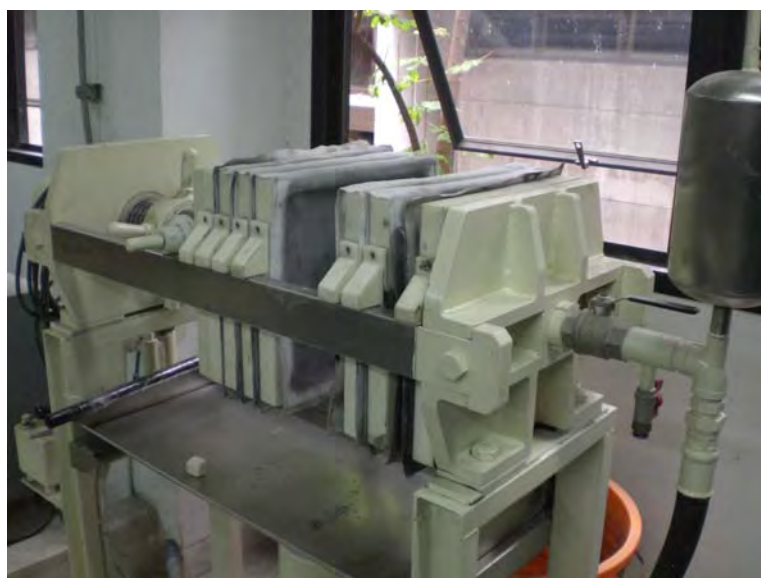
รูปที่ 3.4 เครื่องอัดกรองน้ำดิน
