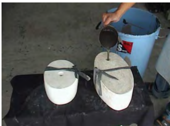
รูปที่ 2.7 การเทน้ำดินใส่แม่พิมพ์ปูนพลาสติก
